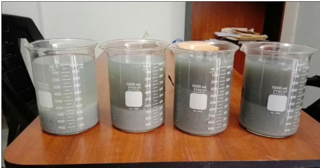
Gráfico N°9: Fotografía del ensayo jarras a 20 ml, 15ml, 10 ml y 5ml de Al 2 O 3 para determinar la concentración óptima.
