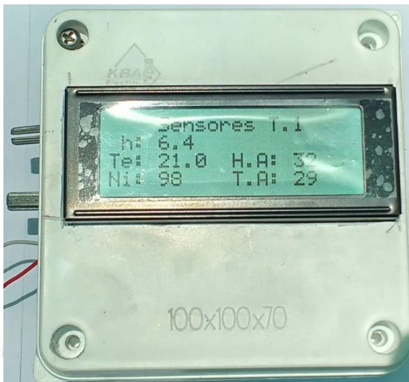
Figura 5.9. Medida del PH, temperatura del agua, humedad y temperatura de ambiente para valores normales mostrados en el centro de control Fuente: (Elaboración propia)
