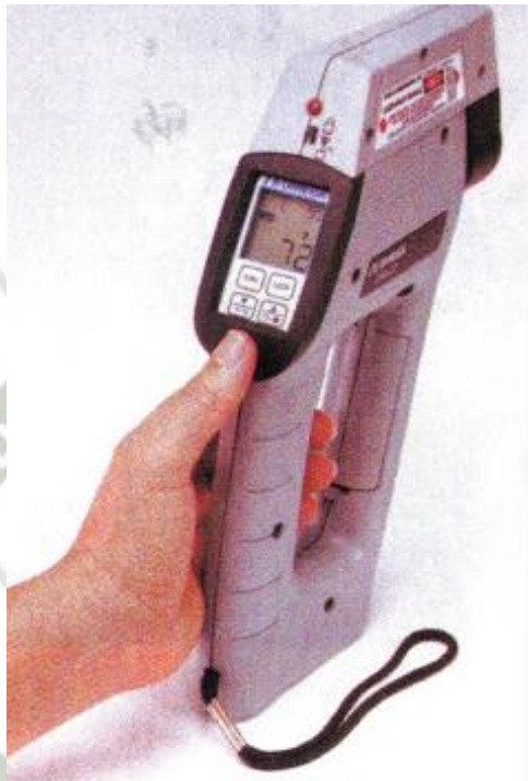
Figura 3.26. Termómetro de no contacto basado en un sensor IR Fuente: (Araya, 2015)
