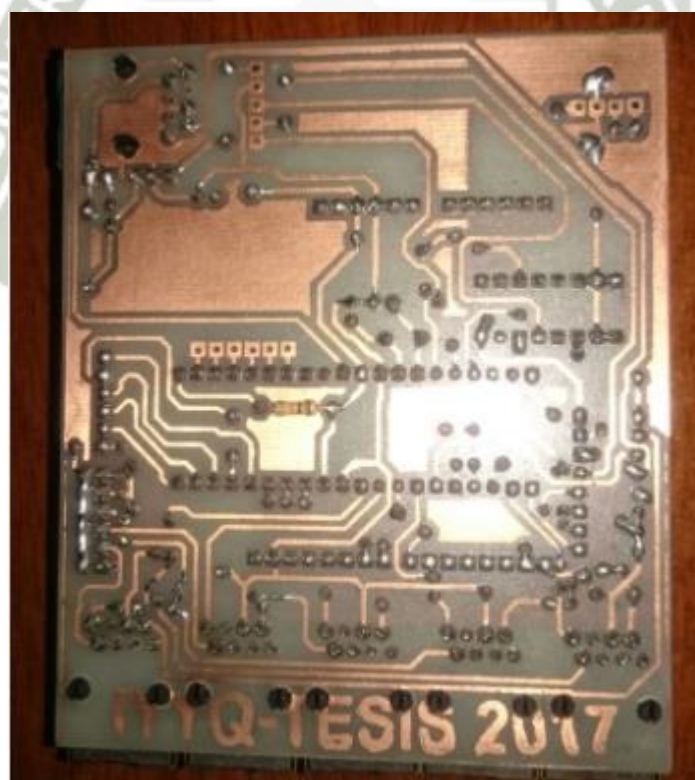
Figura 4.6. Placa impresa del sistema de medición, procesamiento y comunicación de datos Fuente: (Elaboración Propia)
