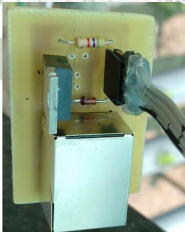
Figura 4.21. Placa de la señal de humedad y temperatura de ambiente Fuente: (Elaboración propia)
