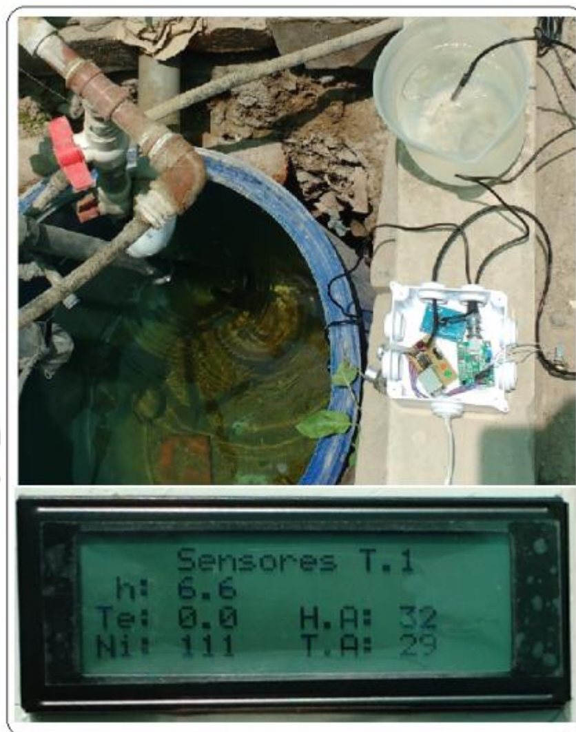
Figura 5.5. Medición de alerta para una temperatura 0.0 °C en la central de monitoreo Fuente: (Elaboración propia)
