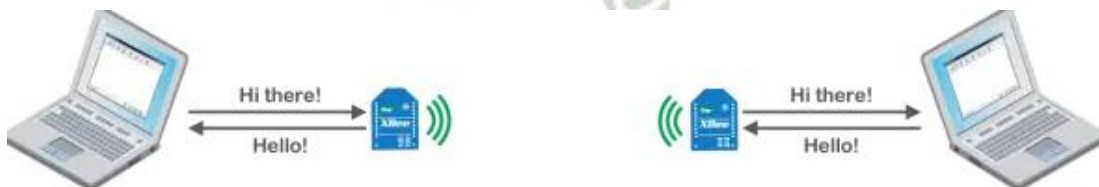
Figura 3.4. Aplicación para transmitir en tiempo real mensajes por el aire con los módulos XBee. Fuente: (Arduino, 2015)
