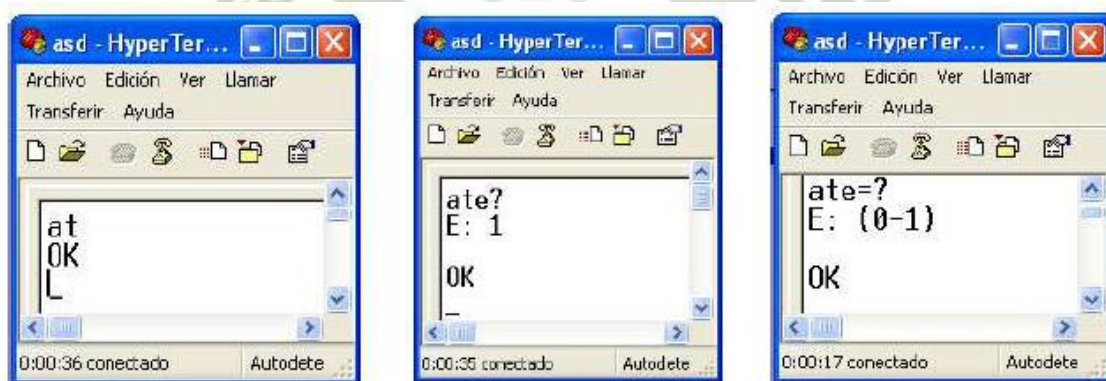
Figura 2.30. Envío de comandos AT Fuente: (Estrada Jimenez & Reinoso Chisaguano, 2009)
