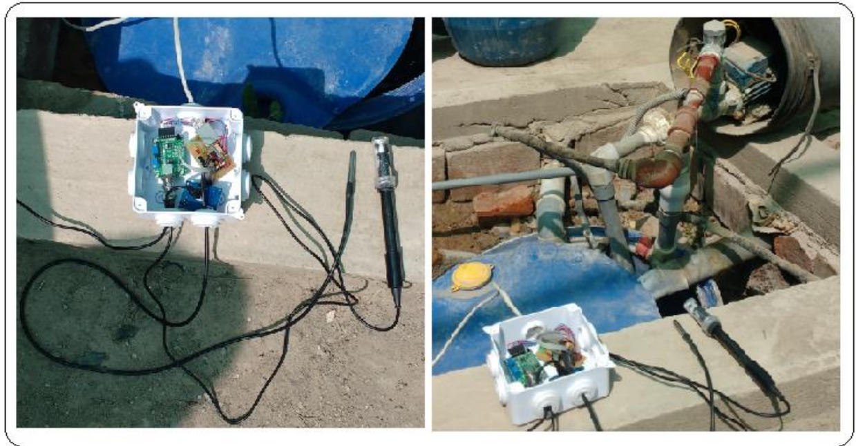
Figura 5.3. Implementación del sistema de medición del PH y la temperatura del agua. Fuente: (Elaboración propia)
