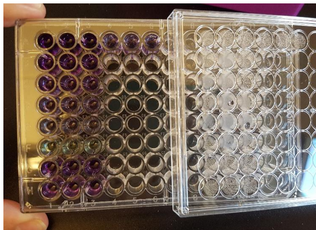
Fig.Nº 10: Microplaca transparente de 96 pozos con soluciones estándar de albúmina y lisado celular.
