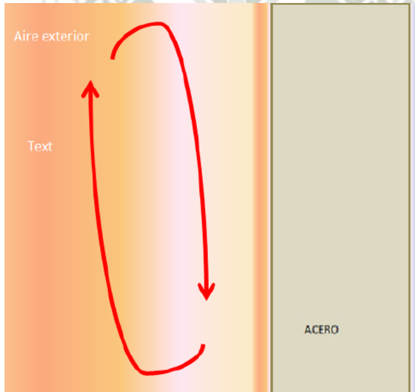
Figura 28. Esquema de la transferencia de calor por convección libre.
