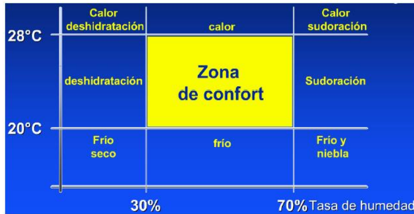
Figura 31. Zona de confort térmico en la cabina del automóvil
