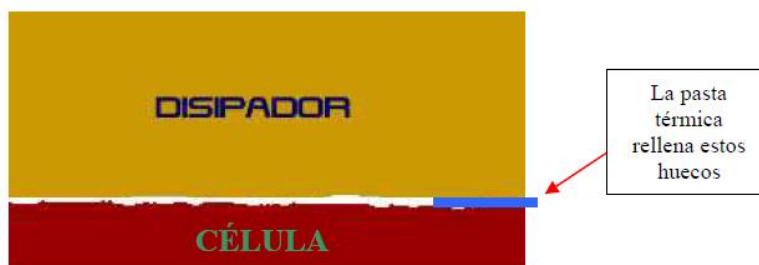
Huecos microscópicos entre célula y disipador
