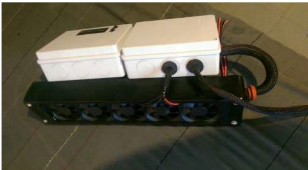
Figura 43. Tapa con el banco de ventiladores y conexionado
