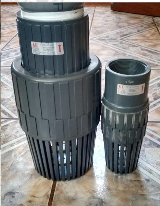
Fotografía 6.7 Válvulas de pie de 3 y 2 pulg.
