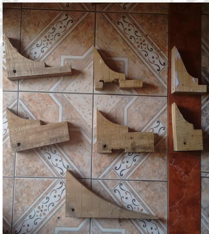
**Fotografía 6.14** Piezas intercambiables de madera que se colocan a continuación del cimacio
