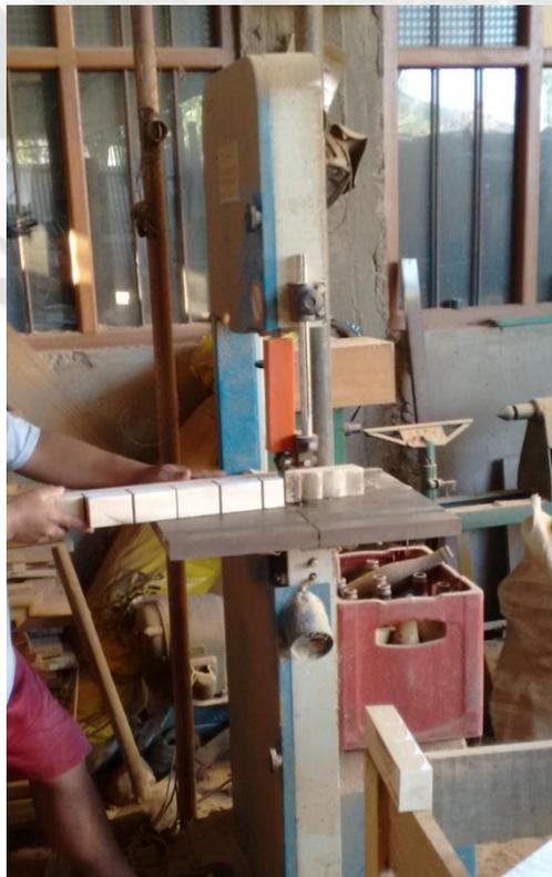
**Fotografía 6.12** Cortadora utilizada para generar las curvas de los perfiles
