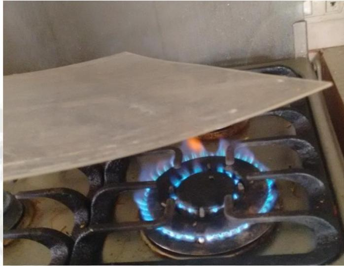
**Fotografía 6.17** Moldeado de la lámina de acrílico por calor.
