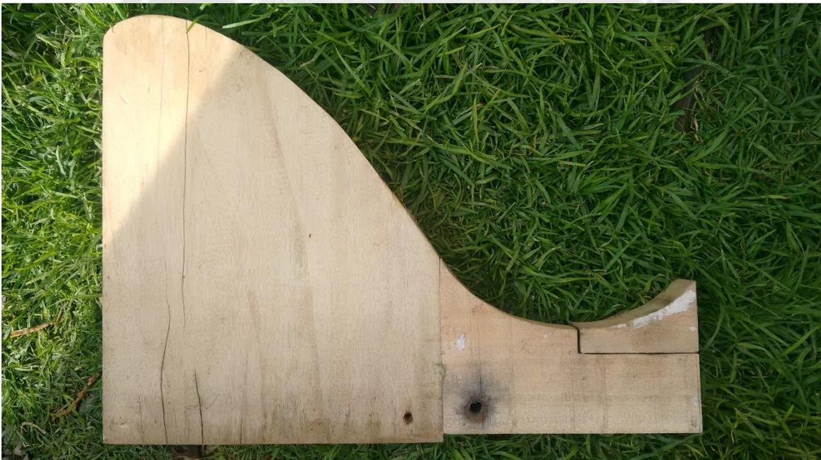
Fotografía. 6.16 Ensamblado de uno de los tipos de aliviadero con salto de trampolín
