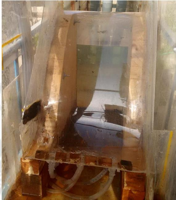
**Fotografía 6.19** Instalación completa del modelo del aliviadero
