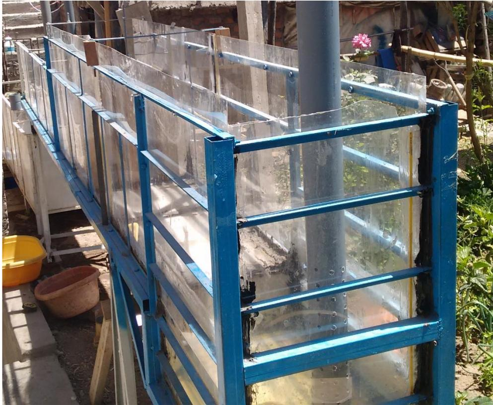
**Fotografía. 6.3** Canal con planchas de acrílico y plancha de cemento
