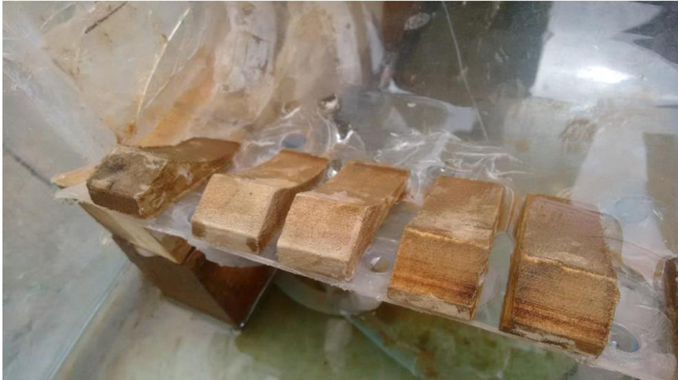
**Fotografía 6.21** Deflectores de madera utilizados en los modelos
