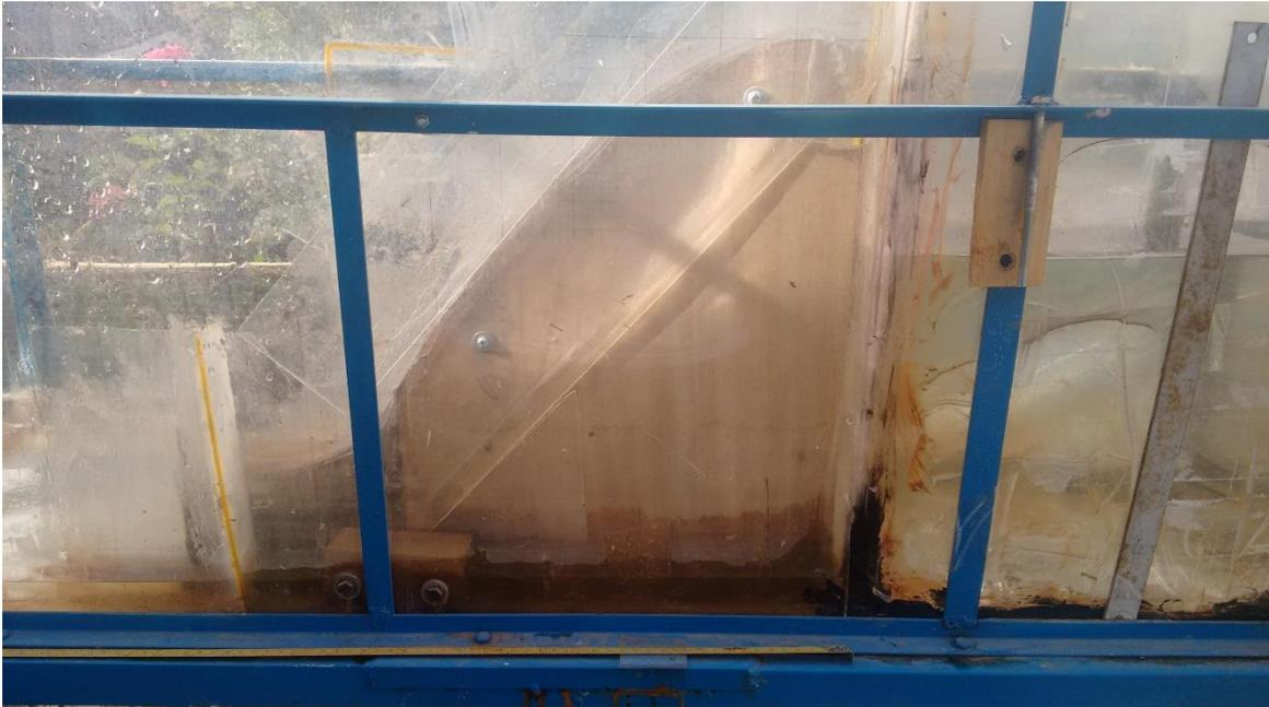
Fotografía 6.15 Modelo del aliviadero instalado en el canal
