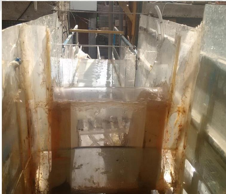
**Fotografía 6.18** Vista trasera del aliviadero, se muestran también los estribos que en el modelo tienen una medida de 5cm
