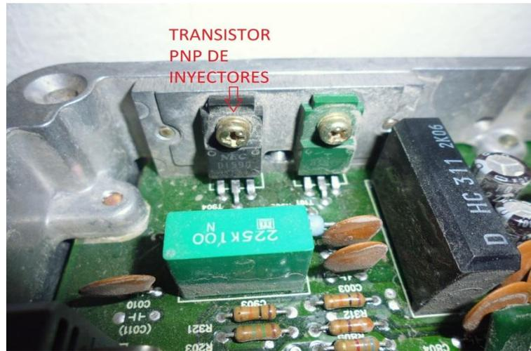
Fig. 3.3-9. Transistor de los inyectores con salida No.10 y No.20.
