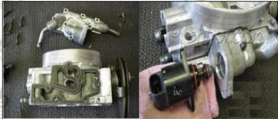
Fig. 2.8-7. Ubicación de la válvula IAC Fuente: [www.checkavanzado.com](http://www.checkavanzado.com)
