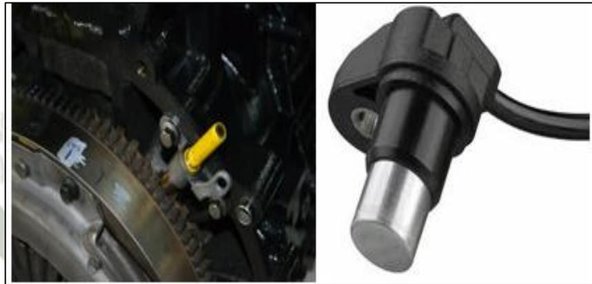
Fig. 2.7-12. Ubicación del sensor CKP. Fuente: [www.checkavanzado.com](http://www.checkavanzado.com).
