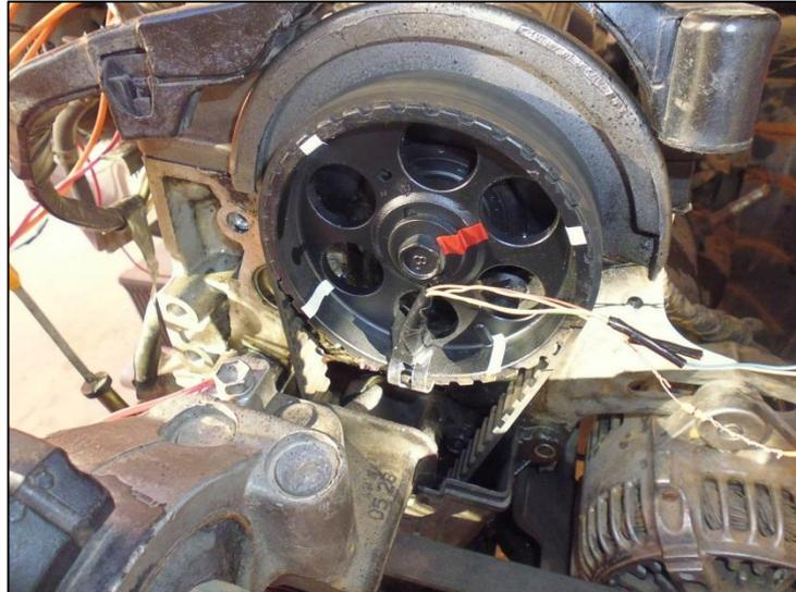
**Fig. 4.2-4. Identificación de inicio de cada cilindro. Fuente: Elaboración propia.**
