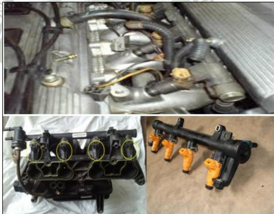
Fig. 2.8-1. Ubicación de los inyectores Fuente: [www.checkavanzado.com](http://www.checkavanzado.com)
