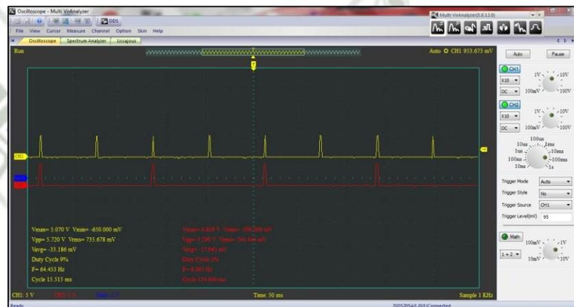
Fig. 4.2-6. Captura de señales con osciloscopio de CMP y CKP. Fuente: Elaboración propia.
