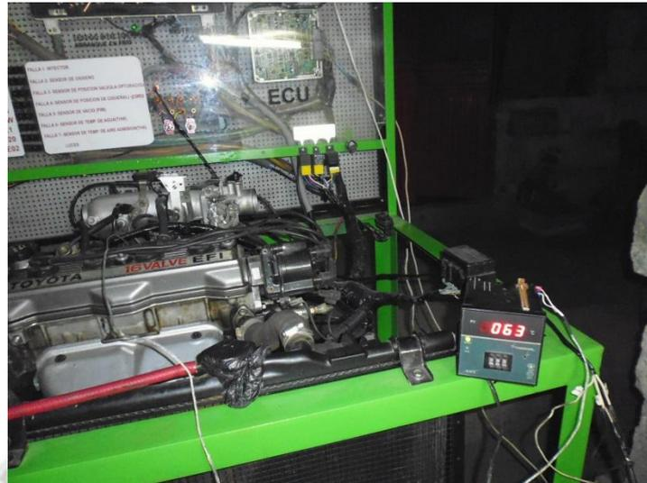
Fig. 4.14-1. Toma de temperatura del motor. Fuente: Elaboración propia.
