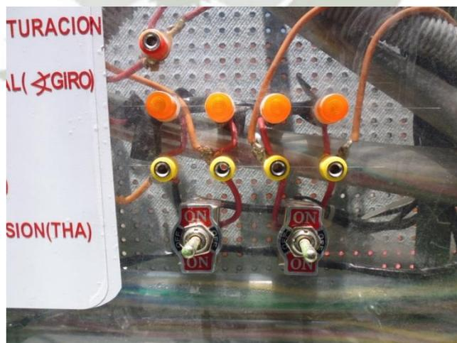
Fig. 4.6-3. Selector de fuente de señal. Fuente: Elaboración propia.
