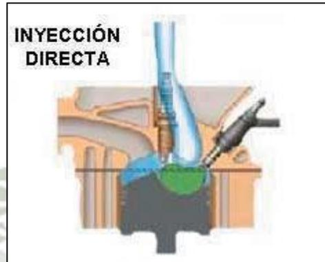
Fig. 2.9-6. Inyección directa. Fuente: GTZ.
