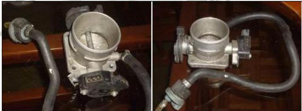
Fig. 2.7-4. Ubicación del sensor TPS. Fuente <http://es.wikipedia.org/wiki/Inyecci>.
