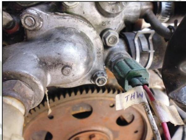
Fig. 3.2-17. Ubicación del sensor THW. Fuente: Elaboración propia.
