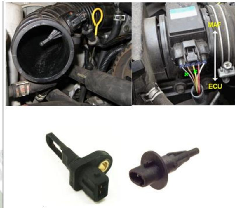
Fig. 2.7-10. Ubicación del sensor IAT Fuente: [www.checkavanzado.com](http://www.checkavanzado.com).
