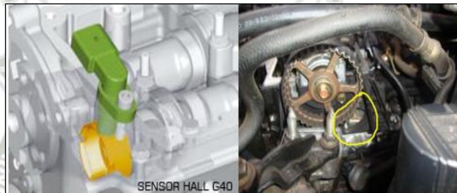
Fig. 2.7-15. Ubicación del sensor CMP Fuente: [www.checkavanzado.com](http://www.checkavanzado.com).
