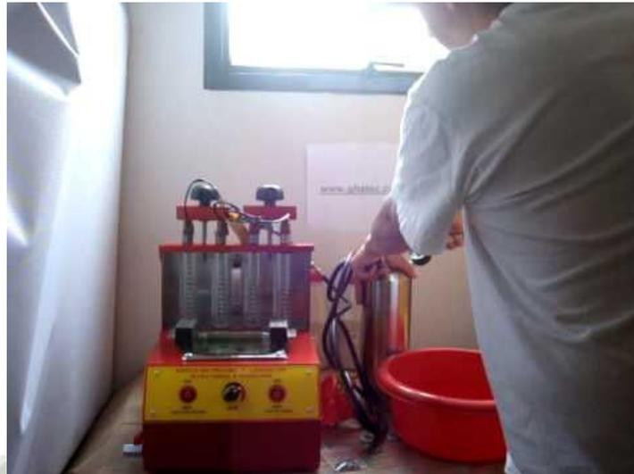
Fig. 4.11-1. Prueba de los inyectores. Fuente: Elaboración propia.
