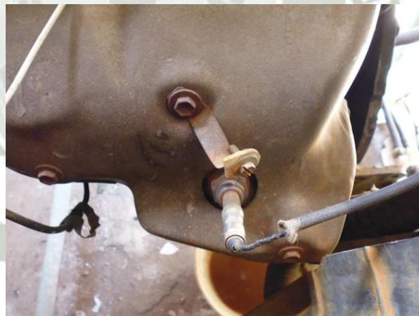
**Fig. 3.2-24. . Ubicación del sensor OX. Fuente: Elaboración propia.**
