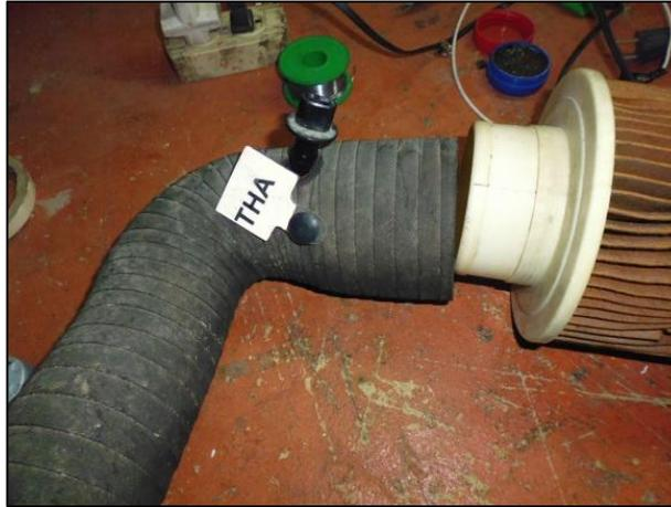
Fig. 3.2-13. Ubicación del sensor THA. Fuente: Elaboración propia.
