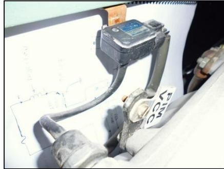
Fig. 3.2-9. Ubicación del sensor MAP. Fuente Elaboración propia.
