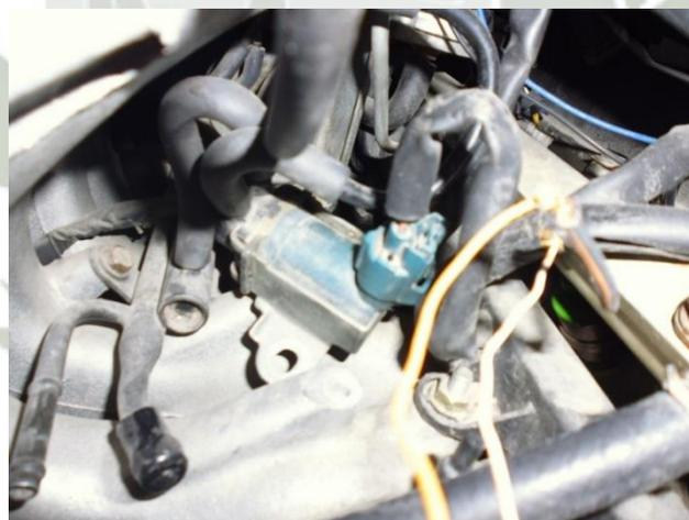
Fig. 3.3-6. Ubicación de válvula de ralentí. Fuente: Elaboración propia.
