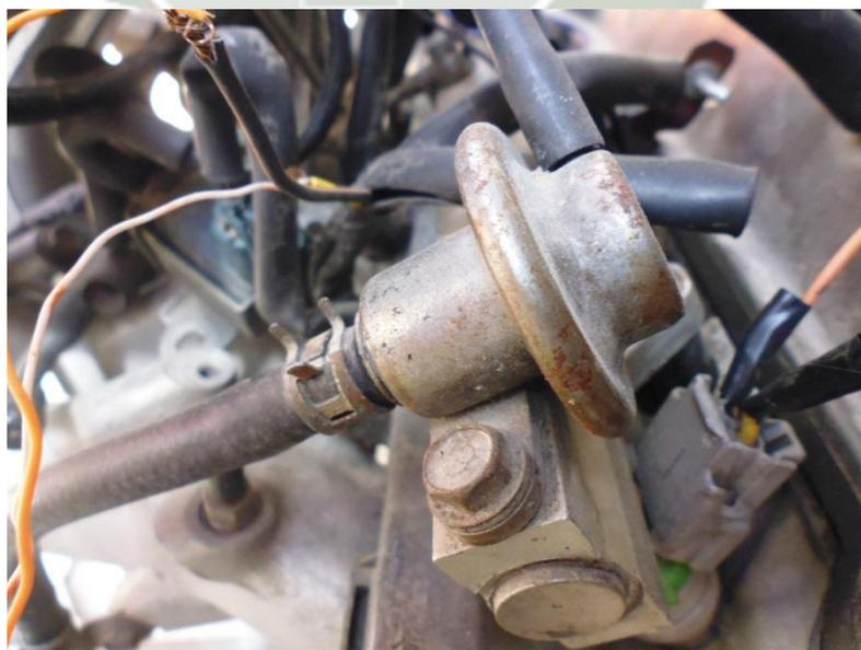
Fig. 3.3-4. Ubicación de regulación de combustible. Fuente: Elaboración propia.
