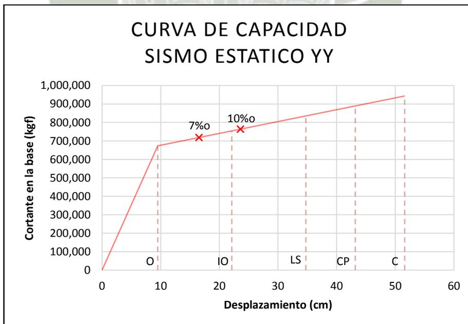
*Figura 9.19 - Curva de capacidad para la dirección YY, distorsiones laterales y rangos de desempeño*
