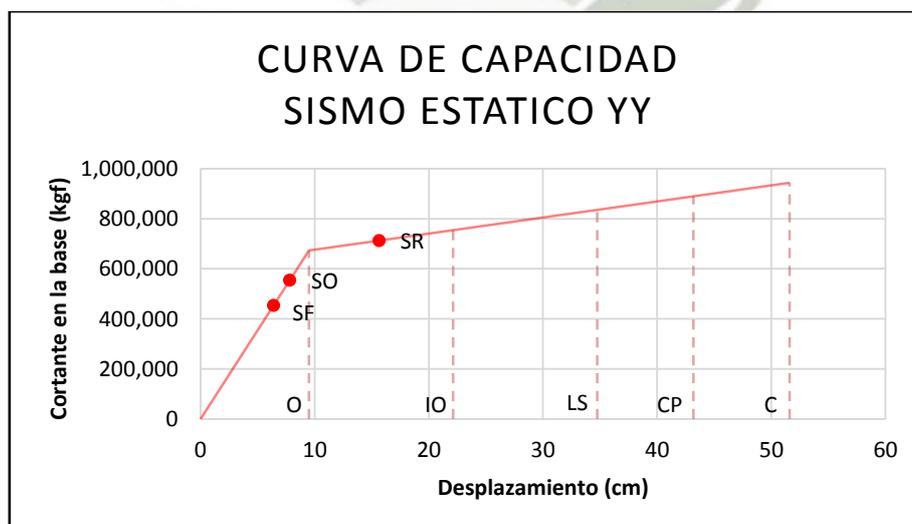
**Figura 9.37 – Curva de capacidad y puntos de demanda para la dirección YY**
