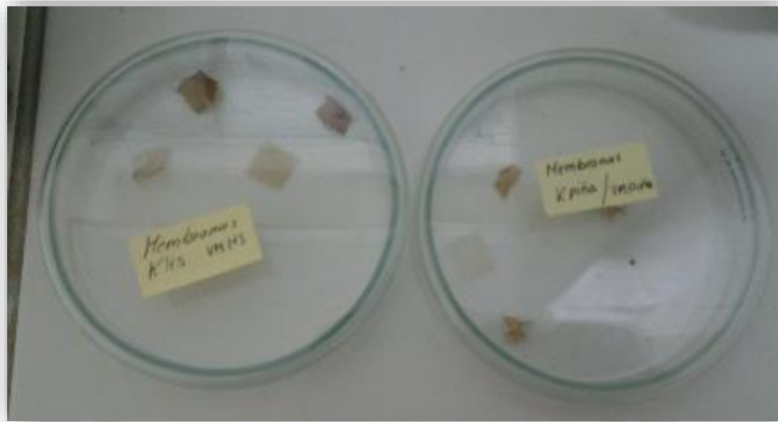
Figura N°61 Membranas de 1cm 2 las que fueron sometidas al ensayo de grado de hinchamiento.
