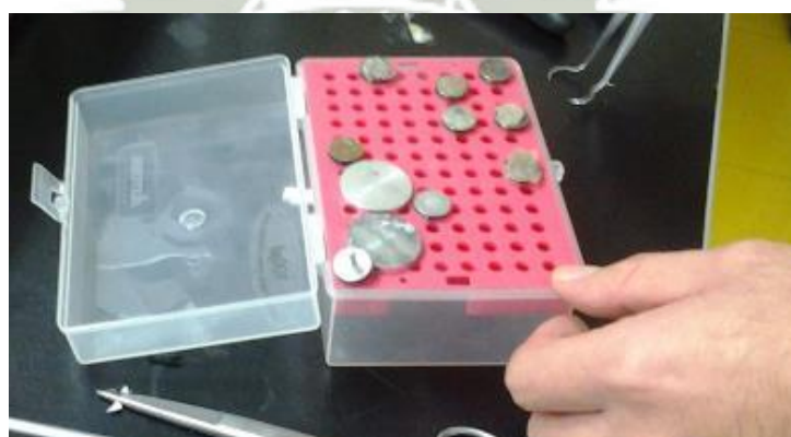
Figura N°40 Muestras metalizadas listas para ser observadas
