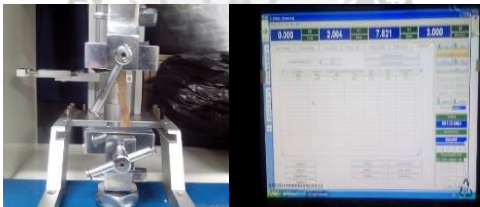
Figura N°60 Medición de tracción simultáneamente al estiramiento se va dando la lectura de los datos con el software.
