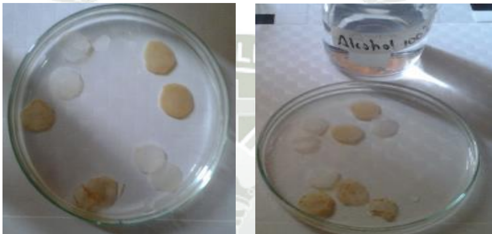
Figura N° 37 Muestras fijadas en glutaraldehído y luego deshidratadas con una batería de alcoholes 50 70 90 % y absoluto.
