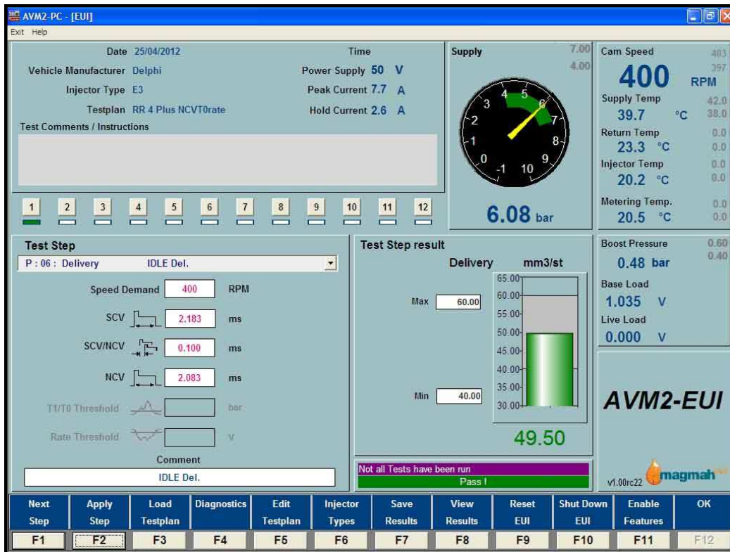
Figura 3.31: Parámetros de funcionamiento Delphi E3 (Semiautomática). Fuente: Elaboración Propia (Hartridge).
