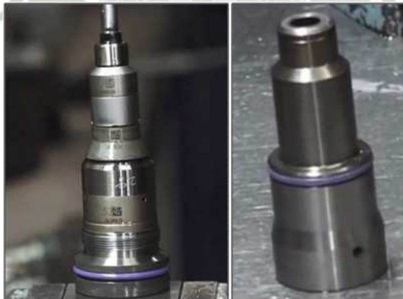
Figura 3.20: Desmontaje del Capuchón Roscado Delphi E3 Fuente: Elaboración Propia.
