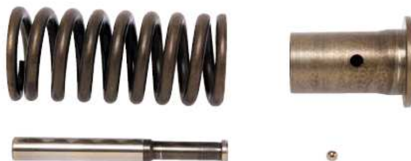
Figura 3.18: Despiece del conjunto Impulsor Fuente: Elaboración Propia.
