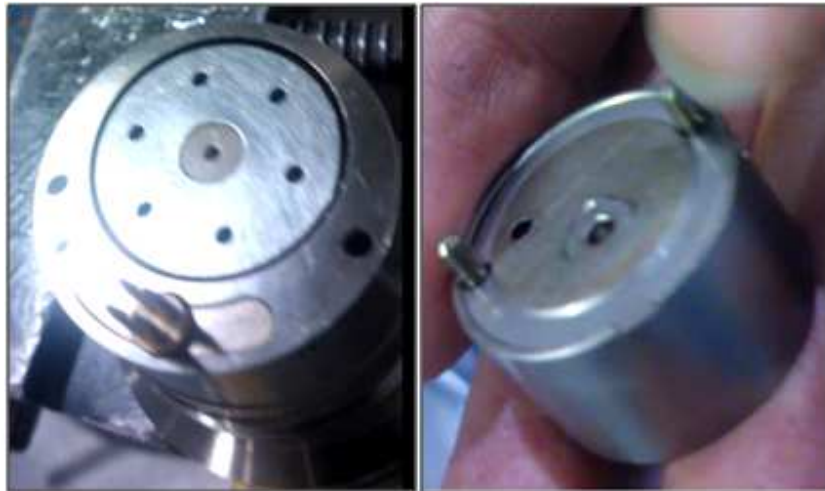
Figura 3.23: Ralladuras o Rupturas en los Módulos Fuente: Elaboración Propia.
