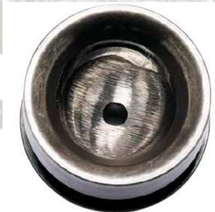
Figura 3.24: Desgaste de Casquillo de Empuje Fuente: Elaboración Propia.
