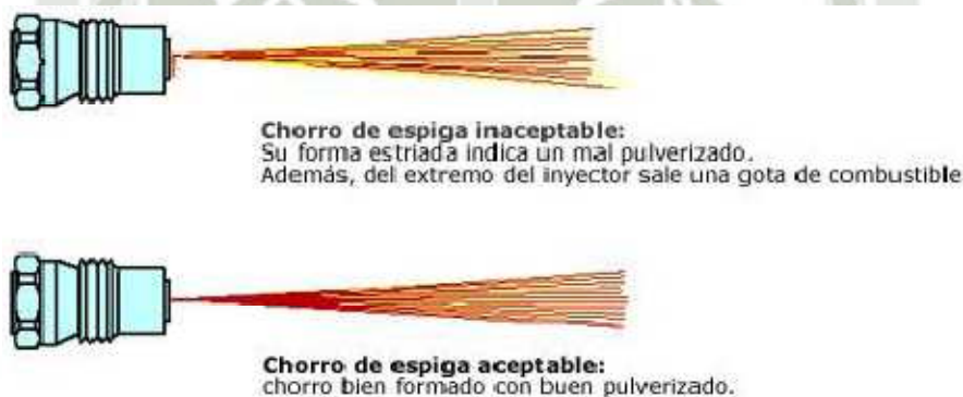
Figura 2.52: Formas de Chorro de Espiga. Fuente: http://www.aficionadosalamecanica.net/hazlo-inyectores.htm .
