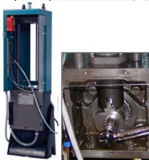
Figura 3.8: Kit básico EUI CAMBOX (HK1502) Fuente: Hartridge.com.
