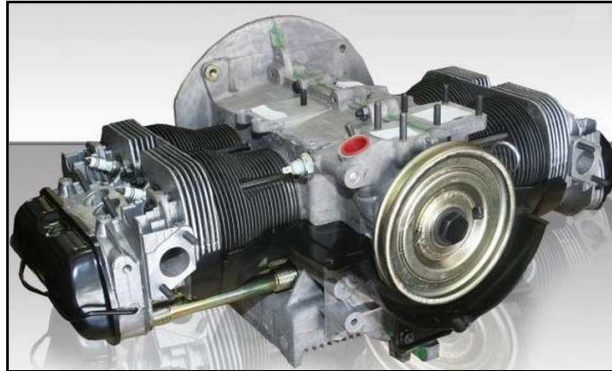
Figura 2.9: Sistema de Refrigeración por Aire de motor Volkswagen Beetle. Fuente: http://es.beetle.com/ .
