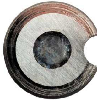
Figura 3.25: Ralladuras de Desgaste en Manguito de Empuje Fuente: Fuente: Elaboración Propia.
