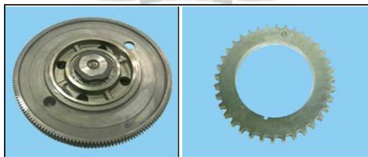
Figura 2.47: Engranaje toro y rueda de tiempo motor Detroit diésel serie 60. Fuente: Conocimientos básicos sistema DDEC. p. 17.
