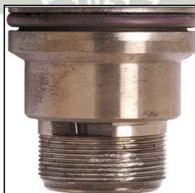
Figura 3.22: Daños en el Cuerpo Roscado del Inyector Delphi E3 Fuente: Elaboración Propia.
