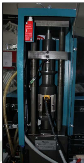
Figura 3.7: Sistema HK1500 para EUI Hartridge Fuente: Hartridge.com.
