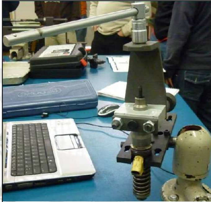
Figura 3.19: Desmontaje del conjunto de Módulos Delphi E3 Fuente: Elaboración Propia.
