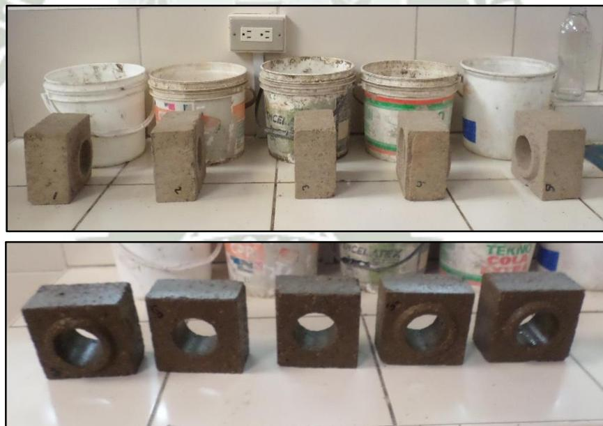
Figura 6-10: Medios ladrillos antes y durante el ensayo de absorción
