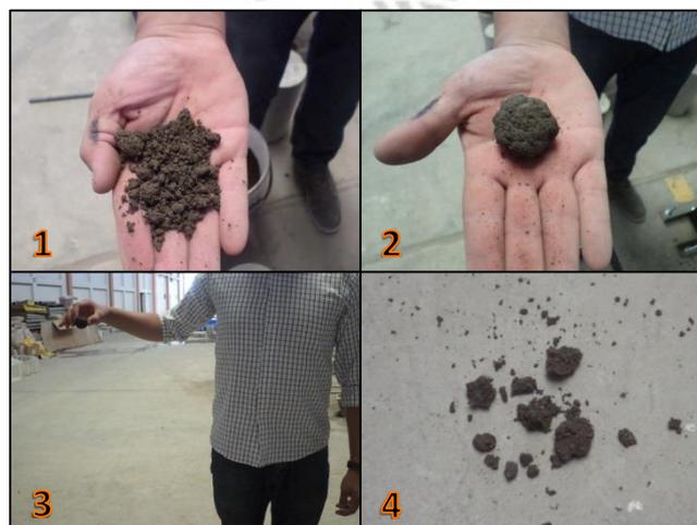
Figura 3-6: Prueba en campo para regular el contenido de humedad de la mezcla.
