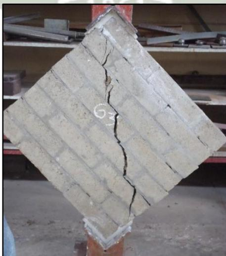
Figura 5-24: Murete sometido al ensayo de tracción diagonal
