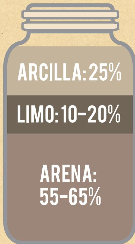
Para determinar si la composición del suelo es la indicada, se recomienda analizarlo en un laboratorio o en su defecto, de manera empírica:
