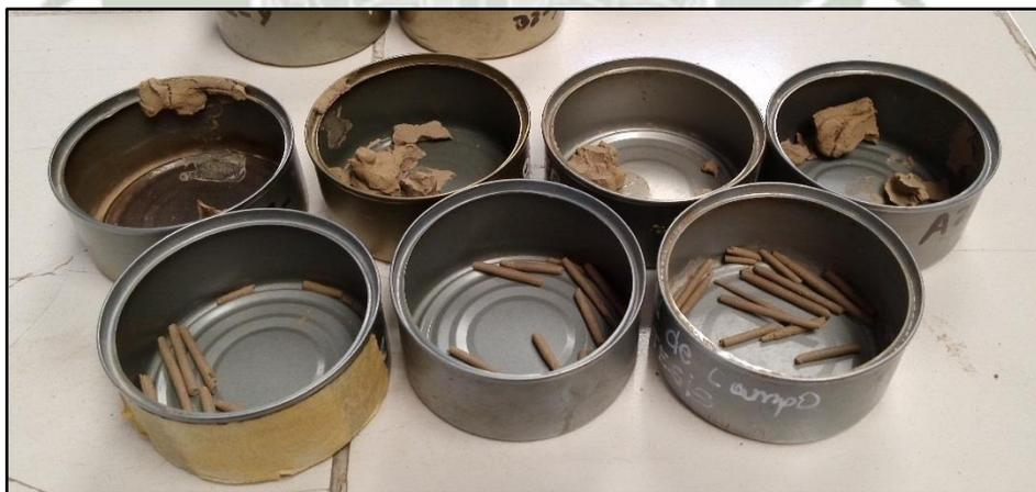
Figura 5-14: Rollitos realizados para determinar el límite plástico del suelo
