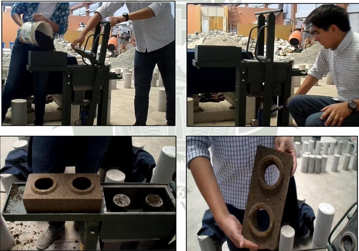
Figura 3-5: Mecanismo de funcionamiento de maquina prensadora
