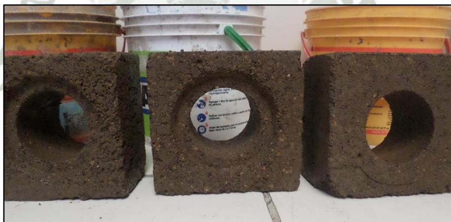
Figura 6-9: Medios ladrillos ensayados para ver su absorción
