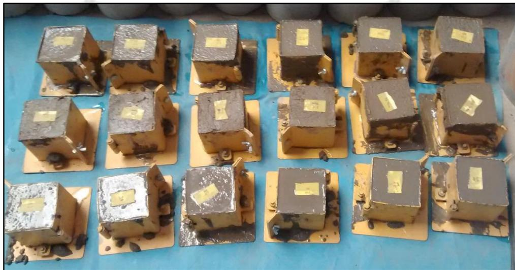
**Figura 6-13: Probetas recién vaciadas.**
