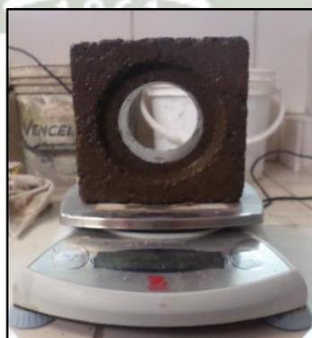
Figura 6-11: Medios ladrillos durante y después del ensayo de absorción
