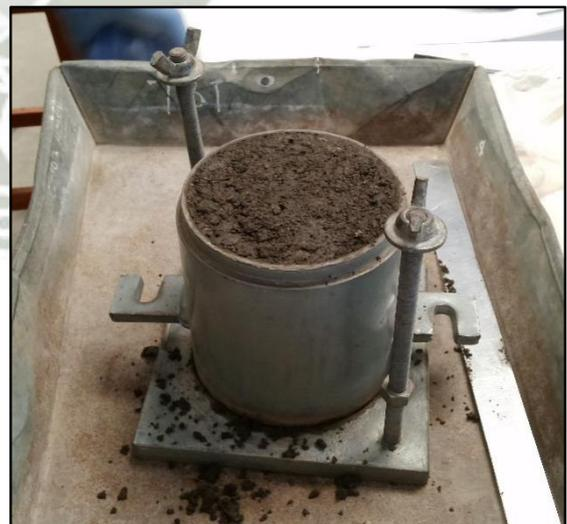
Figura 5-16: Muestra de suelo compactada
