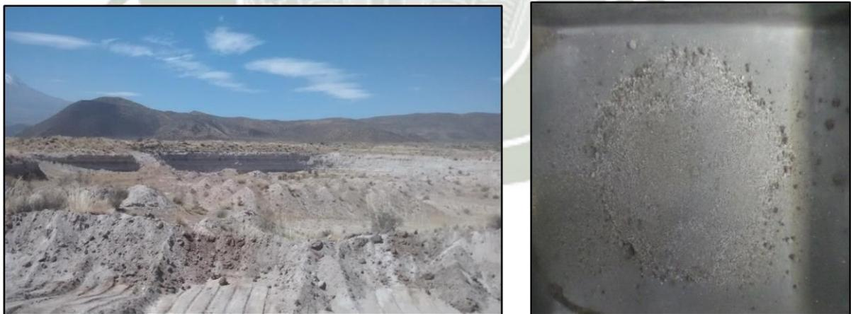
Figura 5-9: Cantera de Arena ceniza y material tamizado por la malla #4
