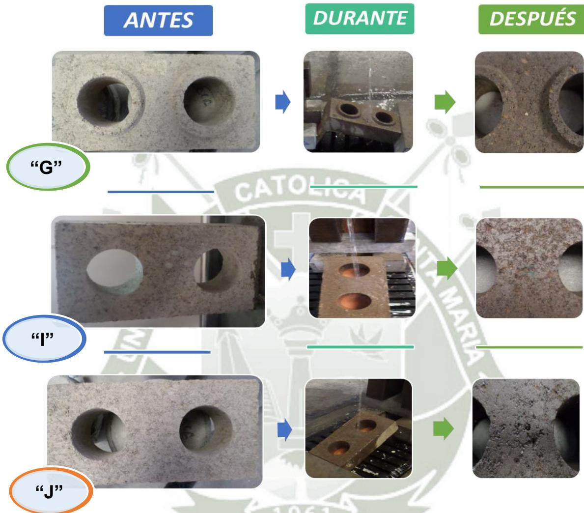
Gráfico 6-34: Ensayo de erosión acelerado para los 3 diseños finales
