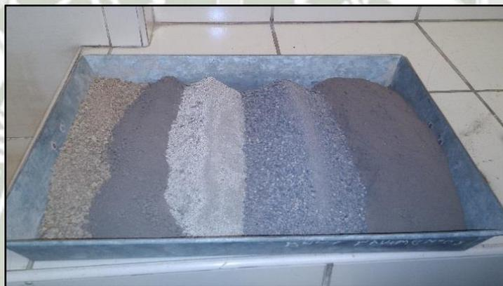
**Figura 3-1: Estabilización Física, mejoramiento de suelo a través de la combinación para cambiar sus propiedades**
