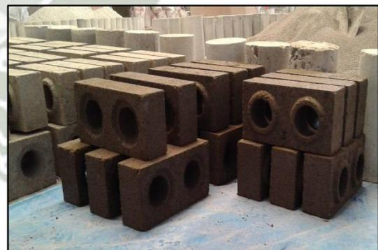
Figura 3-8: Curado y secado de los ladrillos suelo-cemento
