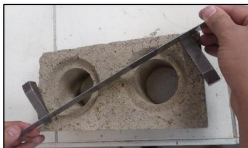
Figura 5-23: Determinando alabeo por convexidad de la cara del ladrillo.
