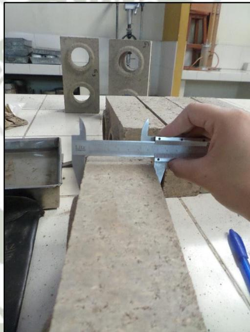
Figura 6-3: Toma de medidas de un espécimen
