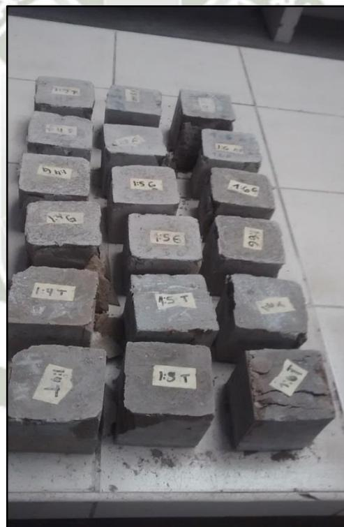
Figura 6-14: Probetas luego de ser sometidas al ensayo de compresión simple
