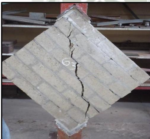
G3: Falla mixta, atraviesa unidad y mortero, en la parte final se falla en la unión de mortero.
