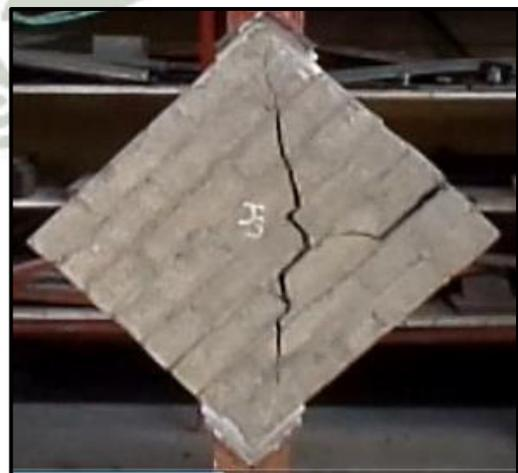
J3: La falla atraviesa la unidad y el mortero, pero en el sector derecho no hay una buena adherencia entre mortero y ladrillo.
