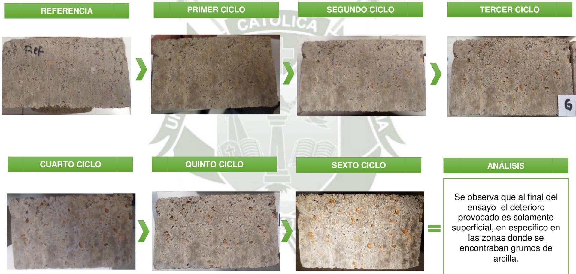
Gráfico 6-30: Ensayo de humectación y secado del diseño G
