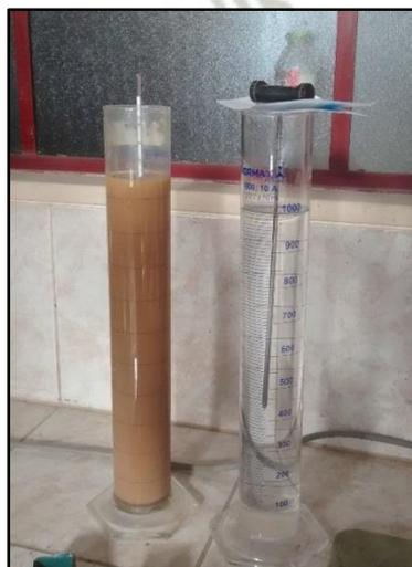
Figura 5-13: Probetas usadas en el ensayo de granulometría por sedimentación para la tierra arcillosa.
