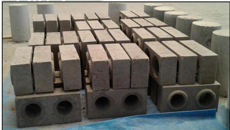
Figura 5-17: Muestra de suelo húmedo para prensarla y ladrillos apilados en la etapa de secado.
