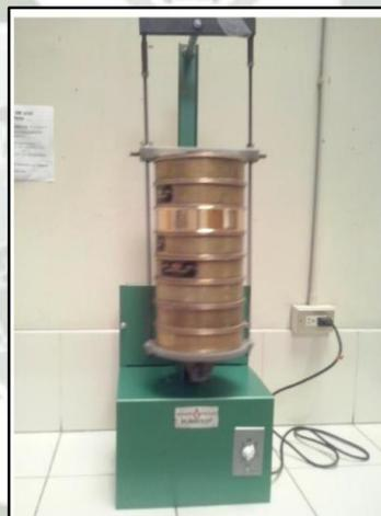
Figura 5-12: Máquina tamizadora
