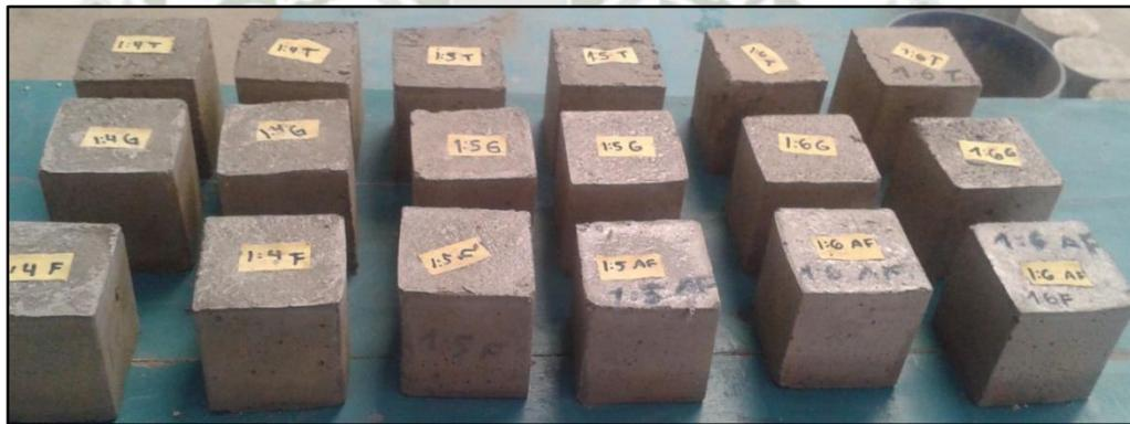
Figura 6-12: Cubos de 10x10 cm para ver la resistencia a la compresión de los morteros
