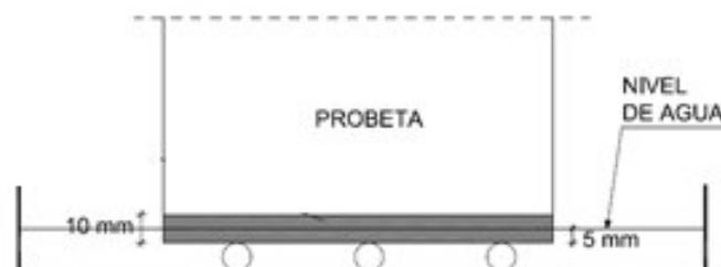
Figura 5-21: Esquema del ensayo de succión
