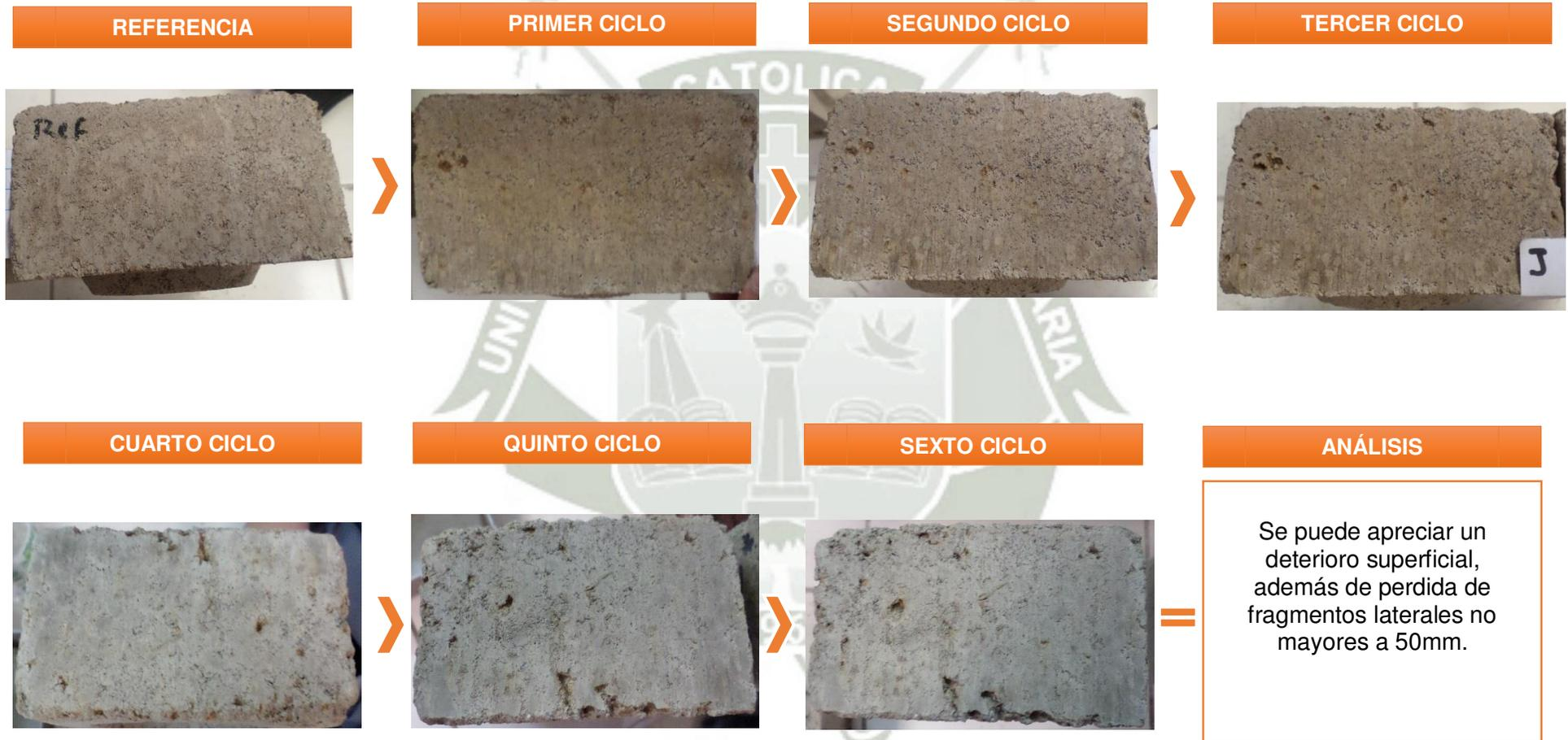
Gráfico 6-31: Ensayo de humectación y secado del diseño I
