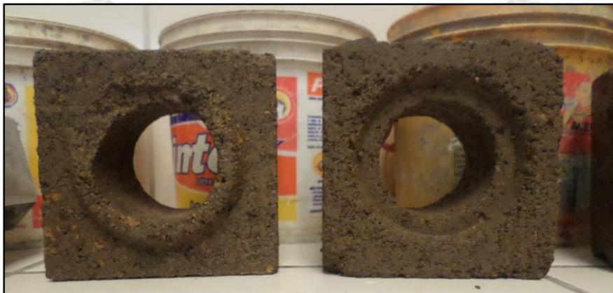
Figura 5-19: Medios ladrillos luego de estar sumergidos por 24 hrs en agua
