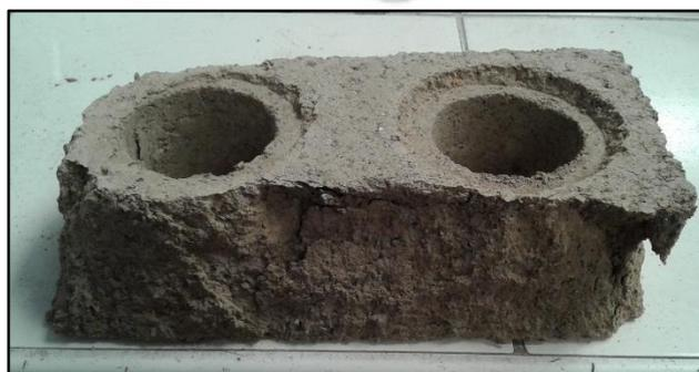
Figura 6-7: Ladrillo suelo-cemento luego de fallar a compresión simple
