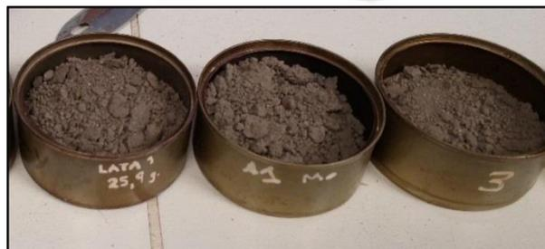
Figura 5-18: Muestras de suelo sometidas al ensayo de determinación del contenido de materia orgánica
