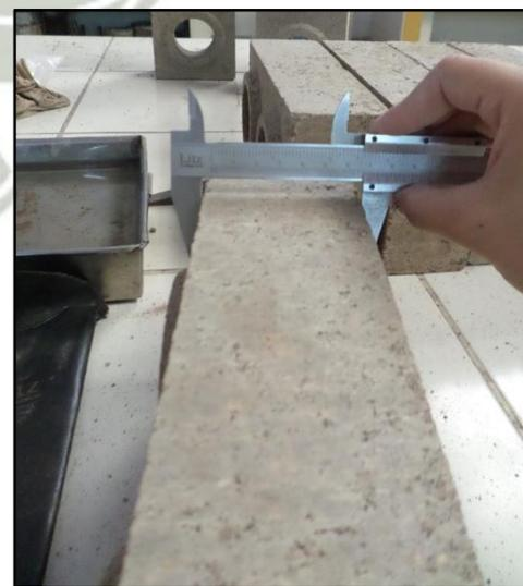
Figura 6-5: Toma de medidas con vernier
