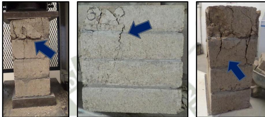
Figura 6-16: Tipos de fallas de las pilas luego de ser sometidos al ensayo de compresión axial
