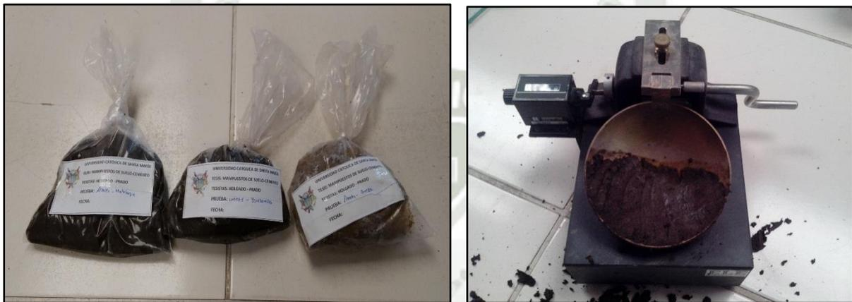
Figura 5-15: Muestras preparadas para los límites y cuchara de Casagrande
