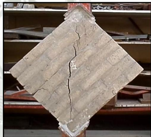
J1: Falla mixta, entre escalonada una pequeña parte y luego solo atraviesa unidad y mortero en la diagonal.
