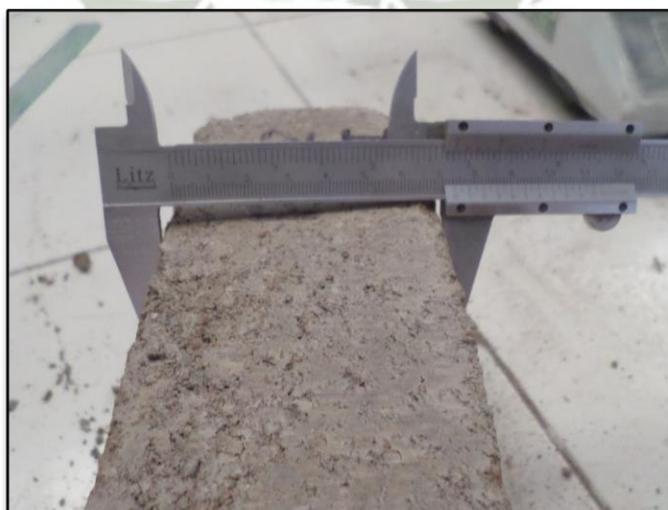
Figura 6-1: Medición de un espécimen con vernier
