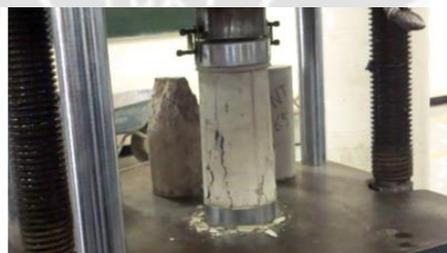
Figura 3.9 - Ensayo a compresión uniaxial de concreto no confinado (Fuente web: <https://www.youtube.com/watch?v=829Ki6IIN34>)
