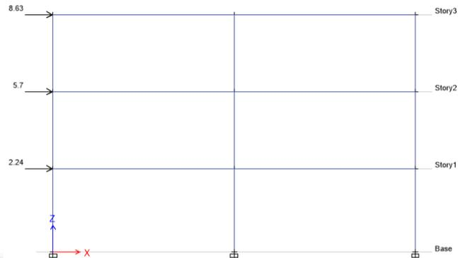
Figura 5.18 - Segundo patrón de cargas amplificado para obtener las siguientes dos rótulas plásticas (Fuente: Autor utilizando Etabs)
