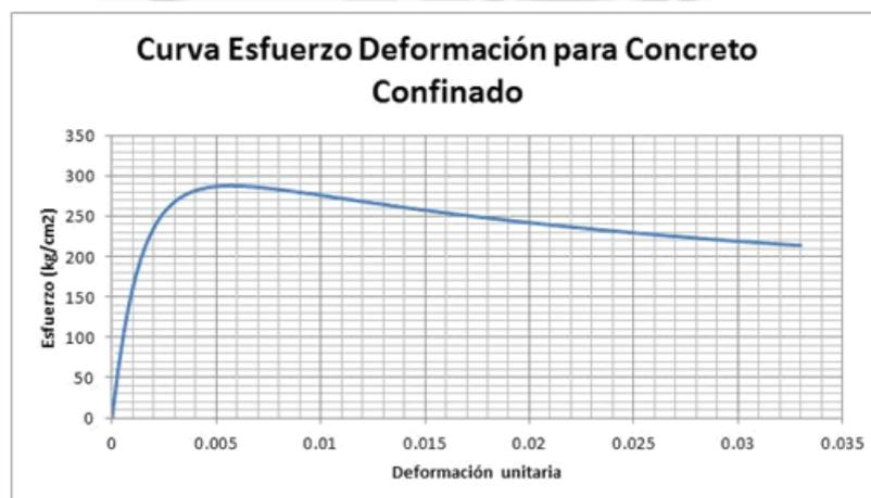
Figura 6.31 - Modelo inelástico del concreto para las vigas (Fuente: Elaboración propia).
