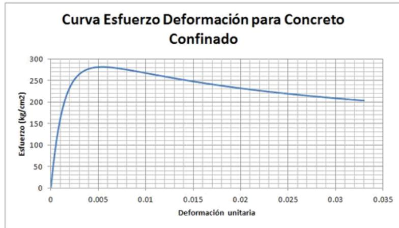
Figura 6.32 - Modelo inelástico del concreto para las columnas (Fuente: Elaboración propia).
