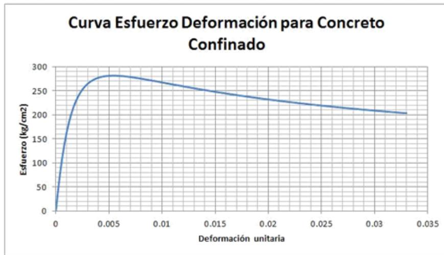
Figura 6.33 - Modelo inelástico del concreto para los núcleos de confinamiento en las placas (Fuente: Elaboración propia).
