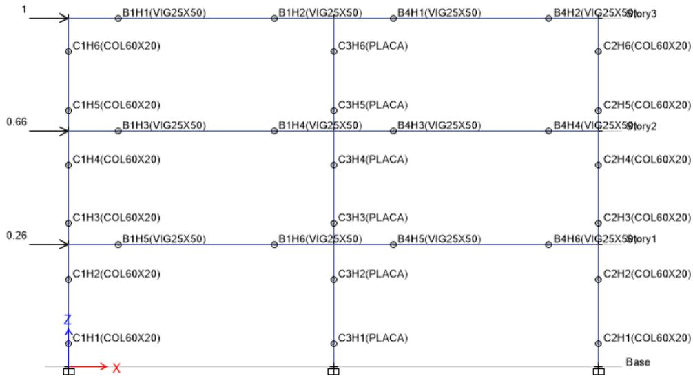
Figura 5.10 - Patrón de fuerzas utilizado para al análisis pushover y ubicación de rótulas plásticas (Fuente: Autor utilizando Etabs).
