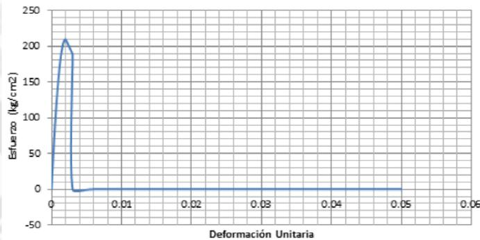
Figura 10.1 – Modelo inelástico para el concreto no confinado (Fuente: Elaboración propia).
