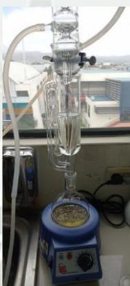
*Figura 9. Extracción Soxhlet para los residuos de maíz. Nota: autoría propia.*
