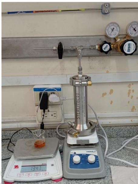
**Figura 13.** Sistema de filtración por membranas asistido con inyección de gas nitrógeno.
