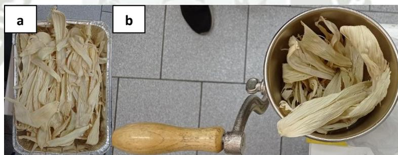
**Figura 8.** Preparación de residuos de maíz. (a) Pancas de maíz secas, (b) Molienda de pancas de maíz. Nota: autoría propia.
