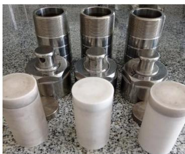
**Figura 6.** Reactores Parr sin agitación empleados para el tratamiento hidrotérmico de los residuos. Nota: autoría propia.
