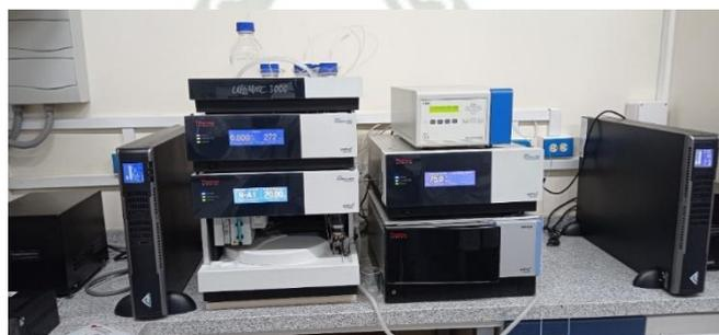
**Figura 7.** Cromatógrafo Líquido de Ultra Alto Rendimiento (UHPLC) utilizado para la cuantificación de xilosa y XOS. Nota: autoría propia.
