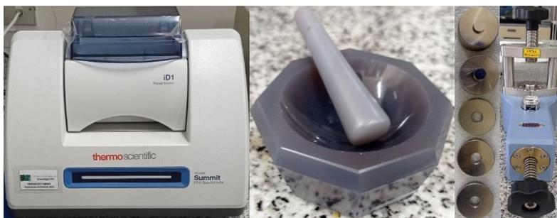
**Figura 5.** Equipo de FTIR y accesorios empleados para el análisis de hemicelulosa cruda obtenida. Nota: autoría propia.
