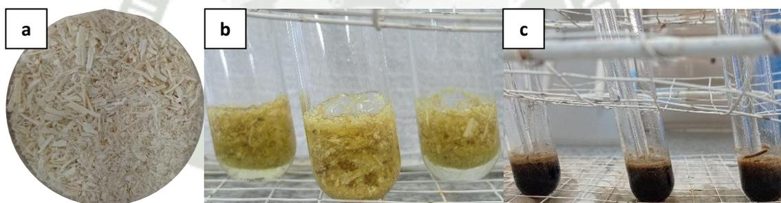
**Figura 10.** Determinación de carbohidratos estructurales y lignina; (a) Material libre de extractivos, (b.) Adición de  $H_2SO_4$  al 72% p/p, (c) Muestras al culminar la incubación de 60 minutos. Nota: autoría propia.
