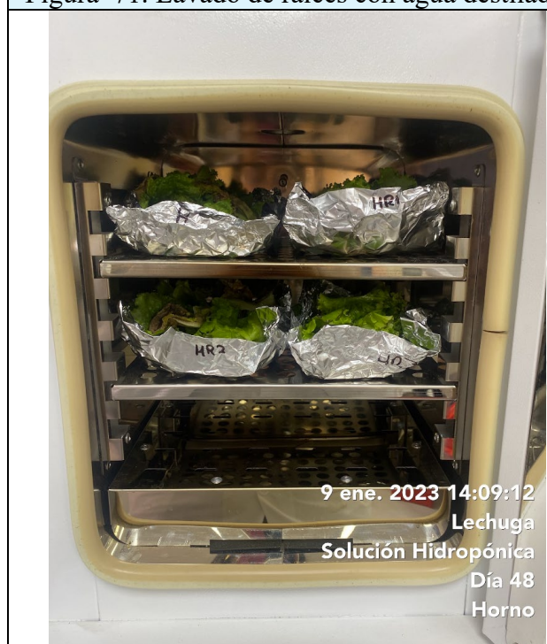
Figura 73. Muestras de especies vegetales en estufa para determinación de peso seco.
