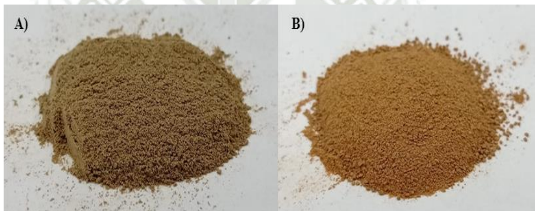
Figura 14. A) LTAP pretratado (LTAPp) y B) LTAP activado a 500 °C (TA-500).
