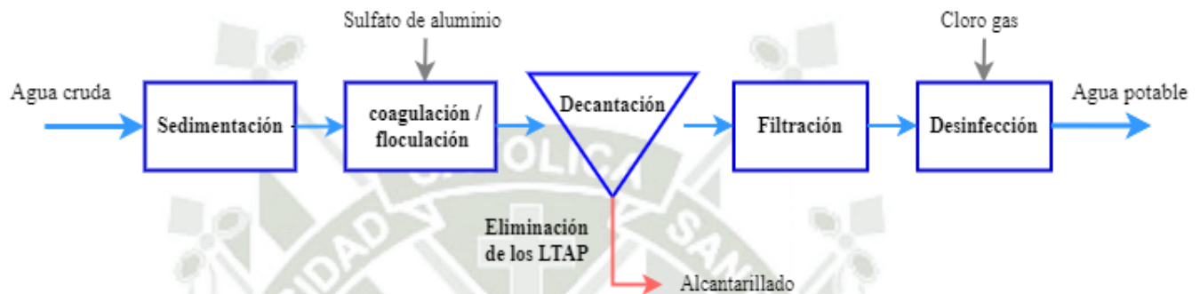
Figura 9. Tren de tratamientos aplicados en la PTAP “La Tomilla” para la potabilización del agua cruda.
