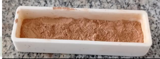
LTAPp después de ser activado a 500 °C
