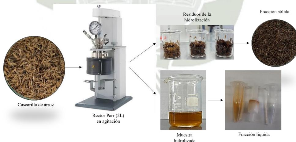
**Figura 9.** Esquematación del proceso de producción de XOS en reactor Parr agitado.
