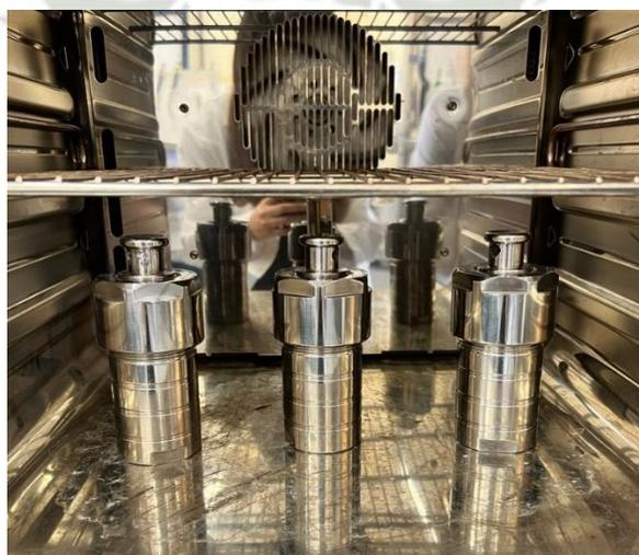
**Figura 29.** Hidrolisis térmica en reactor Parr no agitado.
