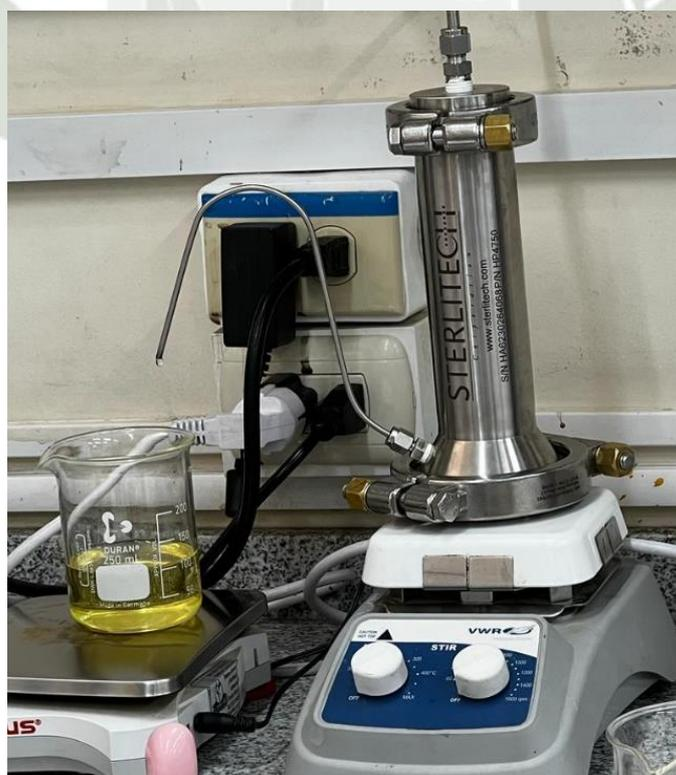
**Figura 31.** Purificación de XOS por ultra y nano filtración por membranas.
