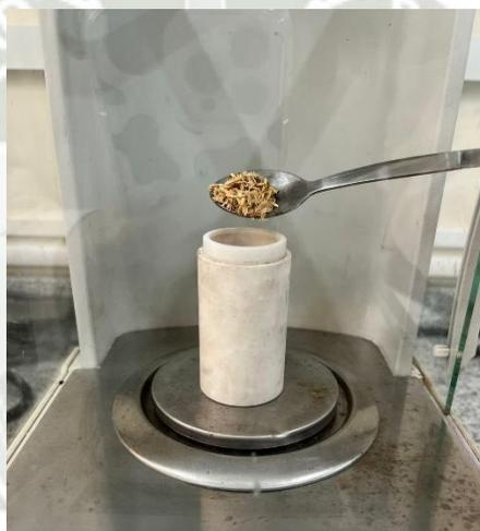
**Figura 28.** Muestra de cascarilla de arroz para hidrolisis térmica en reactor Parr.
