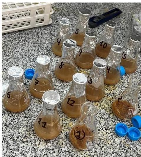
**Figura 27.** Experimentos de extracción alcalina para extracción de hemicelulosa.
