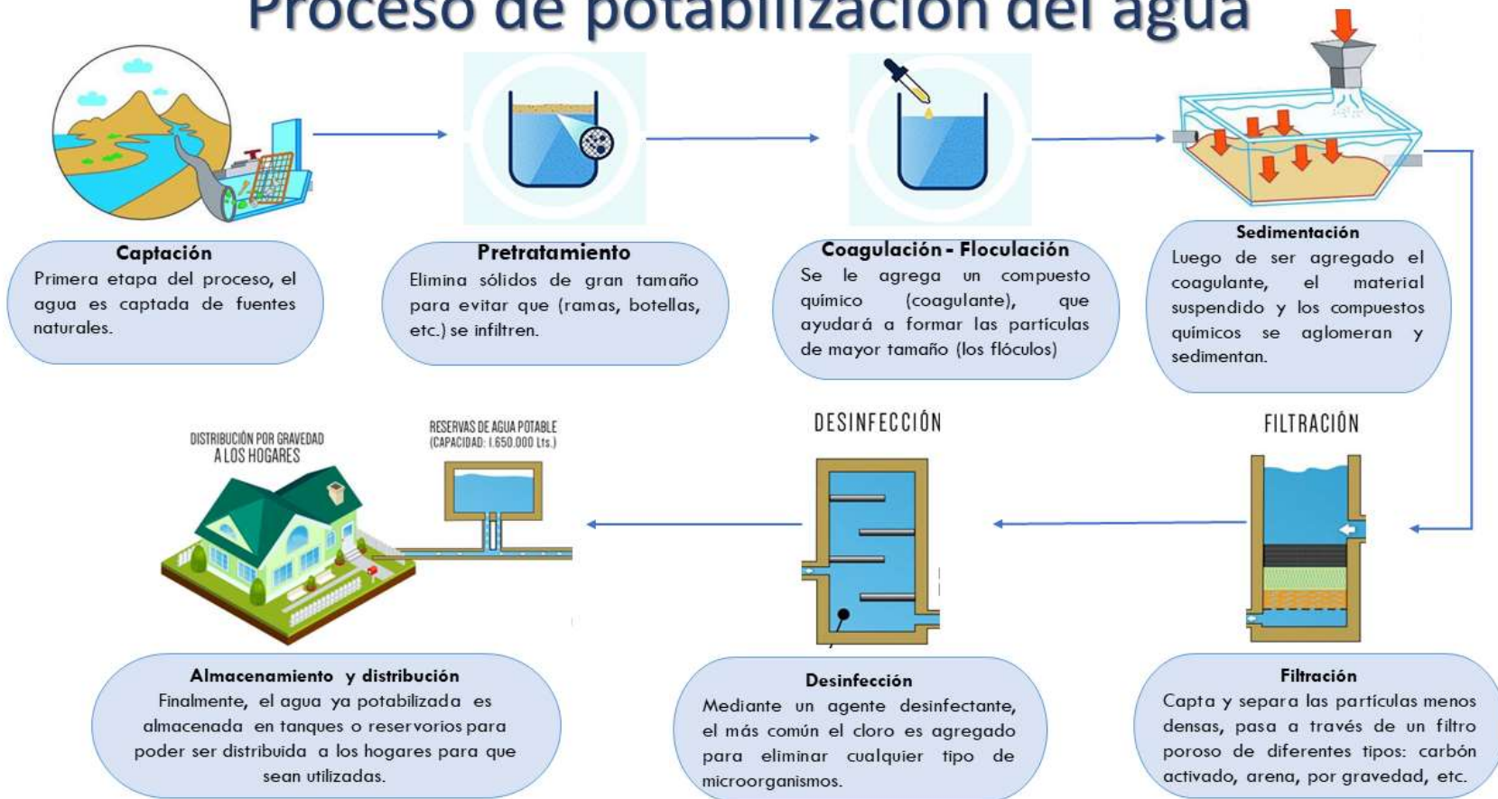
Figura 4. Proceso de potabilización del agua.
