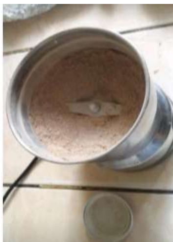
Figura 68. Pulverización de las cáscaras de papa secadas en un molino eléctrico.
