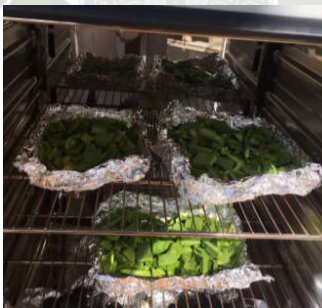
Figura 60. Secado del biofloculante Hylocereus undatus en la estufa.
