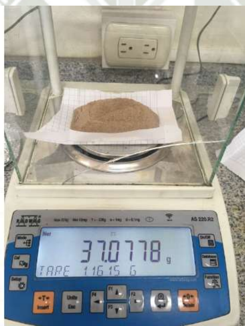
Figura 69. Pesado del biofloculante obtenido a partir de Solanum tuberosum .
