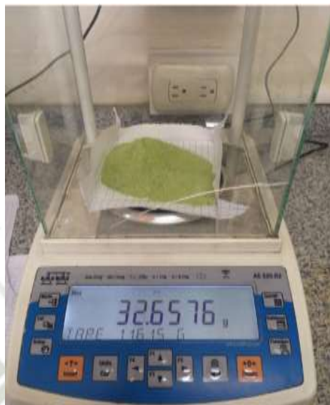
Figura 55. Pesado del biofloculante obtenido a partir de Opuntia ficus indica .
