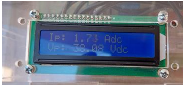
Figura 84. Pantalla de medición, corriente y voltaje del panel solar.
