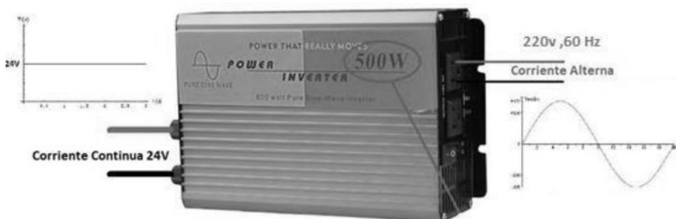
Figura 5. Función de un micro inversor
