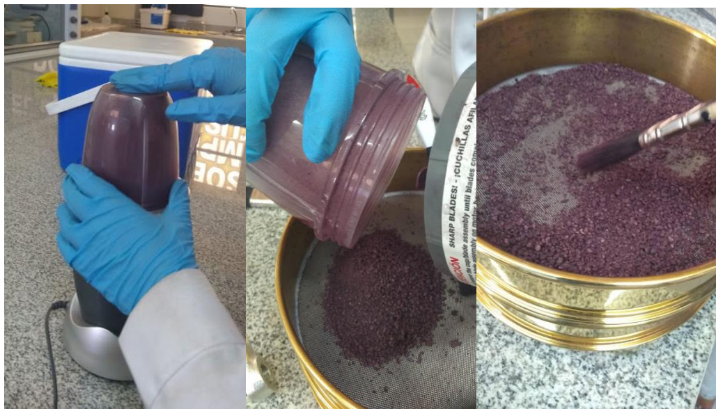
Figura 3.5 Proceso de molienda y tamizado (500um) de muestras de marlo
