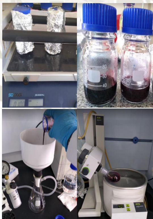
Figura 3.6 Proceso de extracción de antocianinas de muestras de marlo y grano según método de Lao et al (63)
