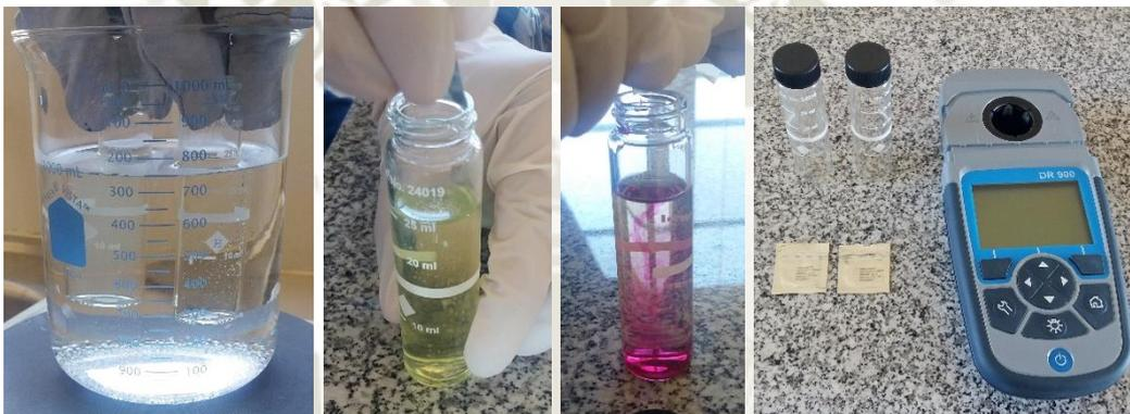
**Figura 16:** *Medición del parámetro de calidad de Cromo Total.*
