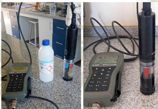
**Figura 15:** *Medición de los parámetros de calidad de Temperatura, pH, Conductividad, Turbidez, Sólidos Disueltos totales (SD) y Oxígeno disuelto (OD).*
