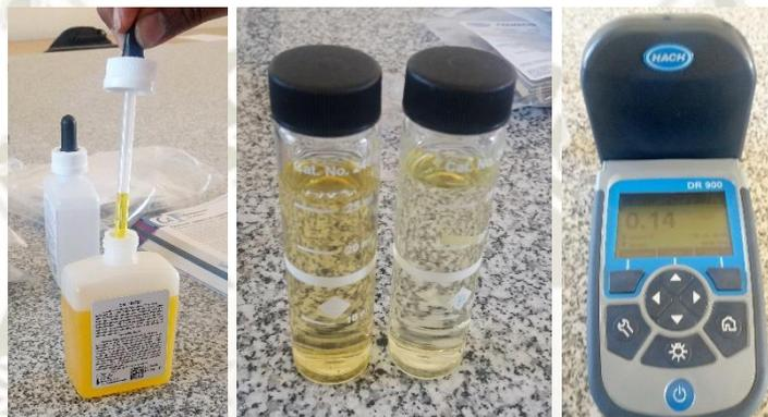
**Figura 21:** *Medición del parámetro de calidad de Sulfuros.*
