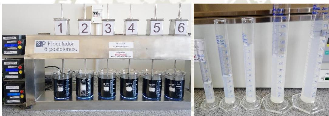
**Figura 13:** Prueba de jarras y dosis de las soluciones coagulantes.
