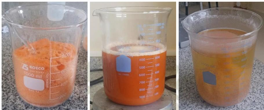
**Figura 8:** *Desmineralización, desproteinización y desacetilación de los residuos de camarón.*
