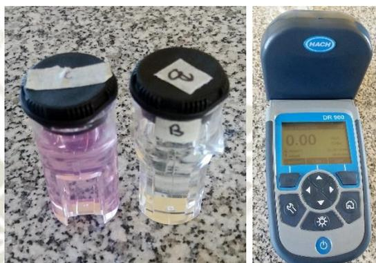
**Figura 17:** *Medición del parámetro de calidad de Cromo Hexavalente.*
