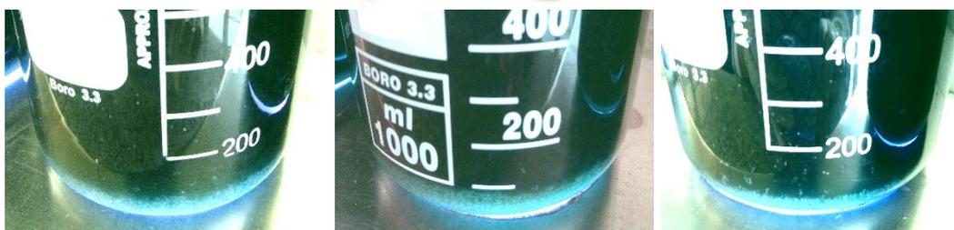
**Figura 32:** *Proceso de Coagulación – Flocculación – Sedimentación con diferentes soluciones coagulantes.*
