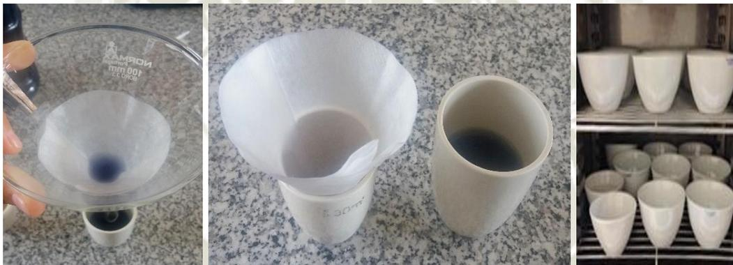
**Figura 20:** *Medición de los parámetros de calidad de Sólidos Suspendedos (SS) y Sólidos Totales (ST).*
