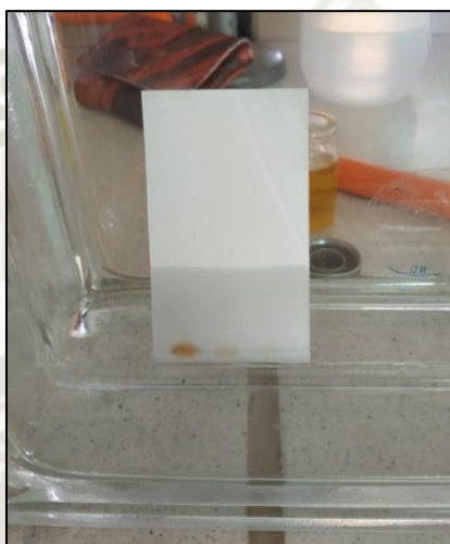
Figura N° 22. Elución de la fase móvil en CCF.
