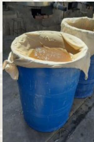
Foto 9: Proceso de Filtrado
