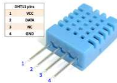
Figura 3. Sensor de temperatura y humedad Dht11 Fuente: (D-Robotics UK, 2010)
