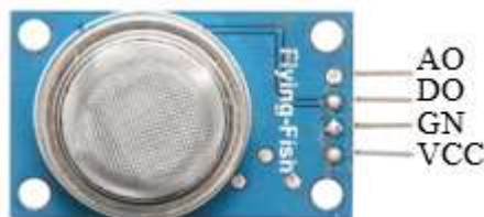
Figura 4. Sensor de gas MQ4 Fuente: (E-Radionica, 2016)
