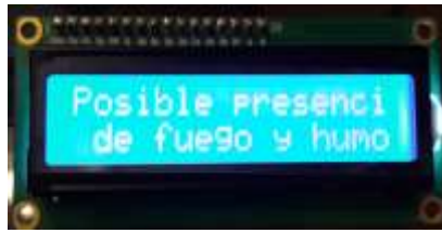
Figura E 31. Pantalla "Posible presencia de fuego y humo" Fuente: Elaboración propia
