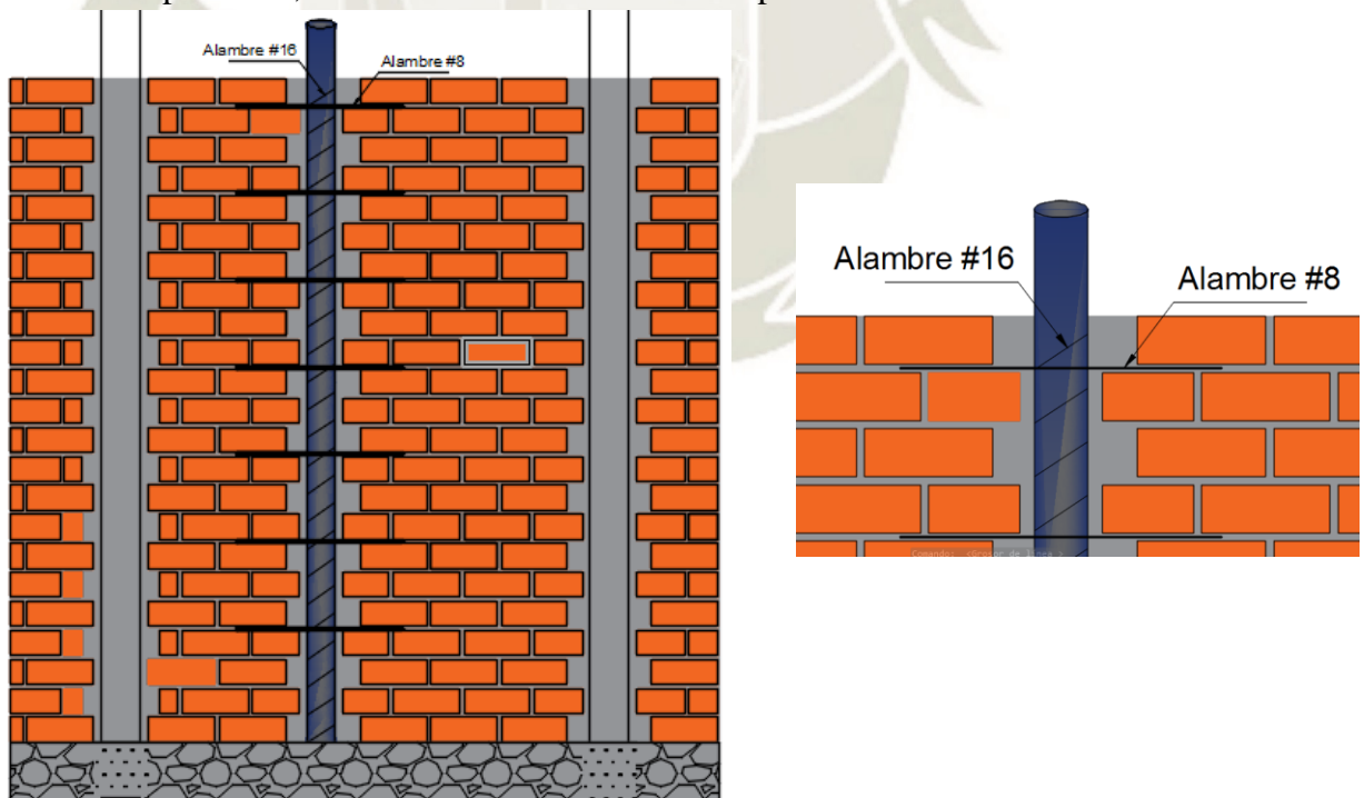
Figura 162: Correcta colocación de tuberías mayores a 5.5 cm.
