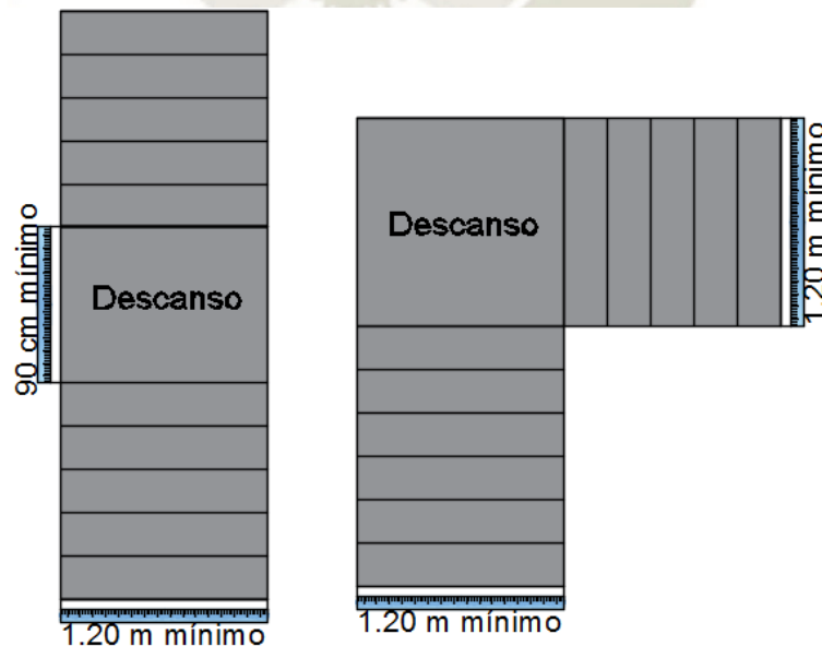
Figura 175: Ancho mínimo de escaleras.
