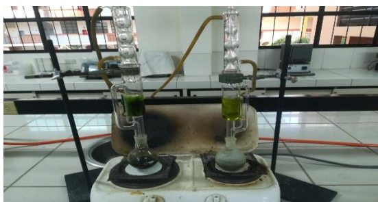
Figura N° 5: Extracción de extractos mediante equipo soxhlet
