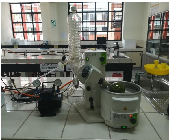
Figura N° 6: Eliminación de los disolventes mediante equipo rotavapor
