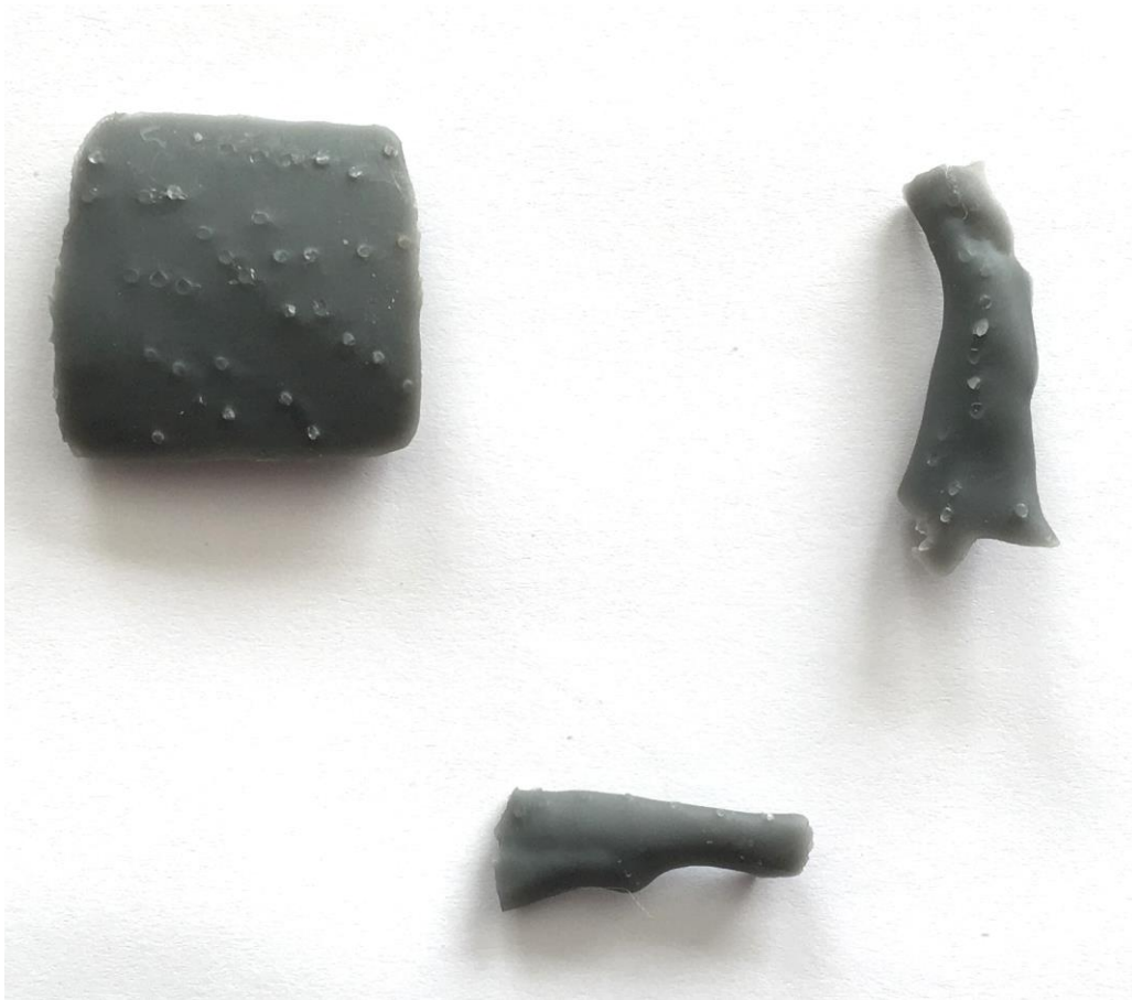
Figura N°19. Retiro de las columnas de resina para la obtención de las impresiones en 3D. Luego se hace un desgaste para retirar pequeños defectos de las columnas.
