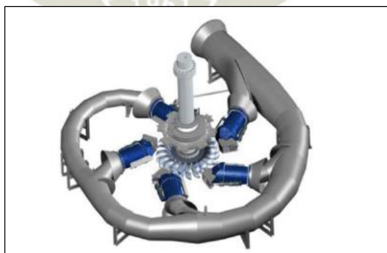
Figura 25: Turbina Pelton de eje vertical.
