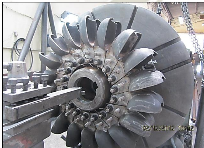
Figura 23: Turbina Pelton de álabes unidos al rodete por medio de pernos. Fuente: http://fymecol.com
