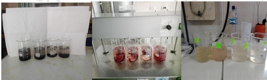
Figura 75.-Tratamiento con Ferrocryl ® y Chemlok 2040® a las 3 muestras de agua residual textil empleando el equipo de prueba de jarras
