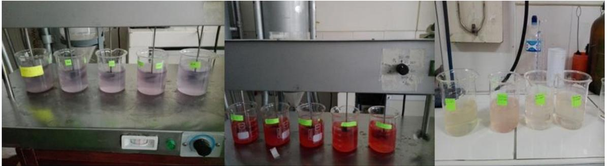
Figura 77.-Tratamiento con mucilago de penca de tuna y sabila a las 3 muestras de agua residual textil empleando el equipo de prueba de jarras
