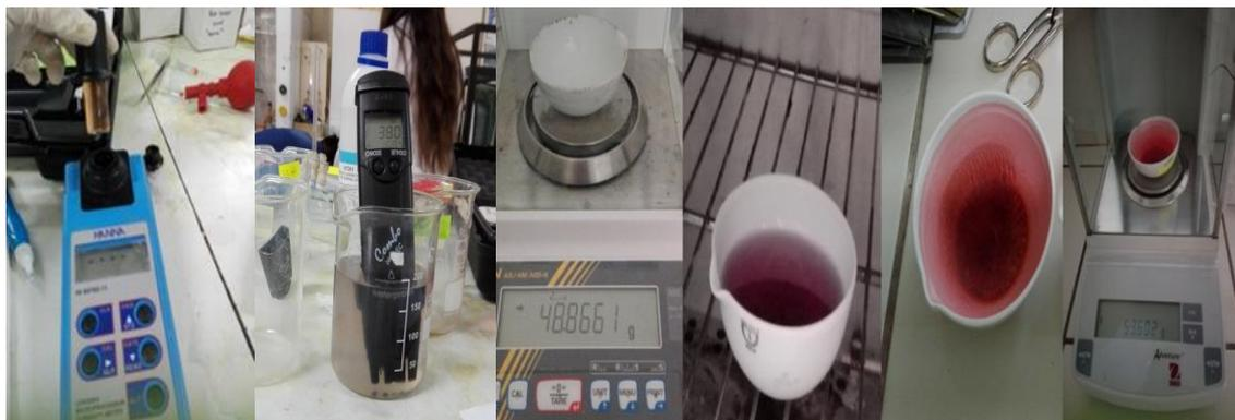
Figura 74.-Medición de los parámetros físicoquímicos: conductividad, turbidez, solidos disueltos, solidos suspendidos, solidos totales y pH a las muestras de agua sin tratar
