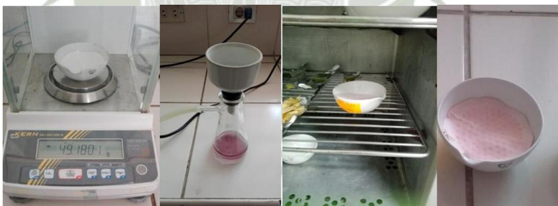
Figura 76 Medición de los parámetros de las muestras tratadas con Ferrocryl ® y Chemlok2040®
