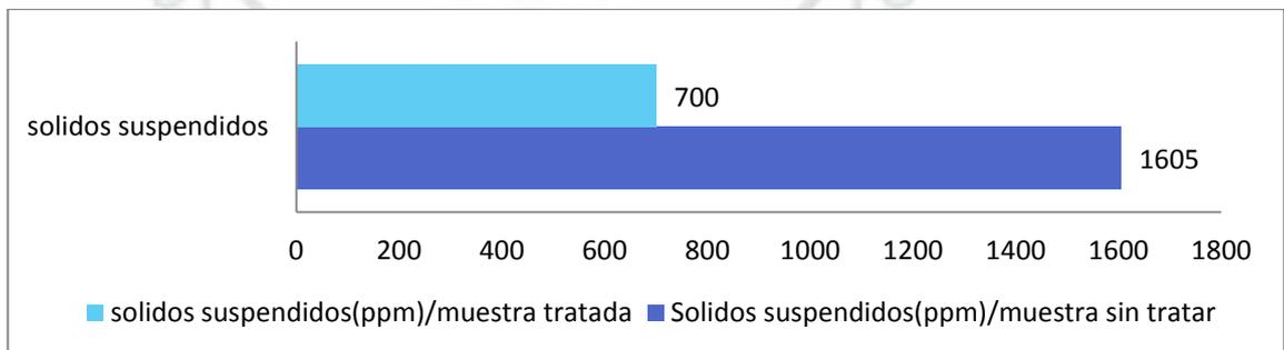
Figura 54. Comparación de solidos suspendidos en la muestra n° 2 sin tratar y tratada con 30% sabila/70% tuna a una concentración de 500g/200ml
