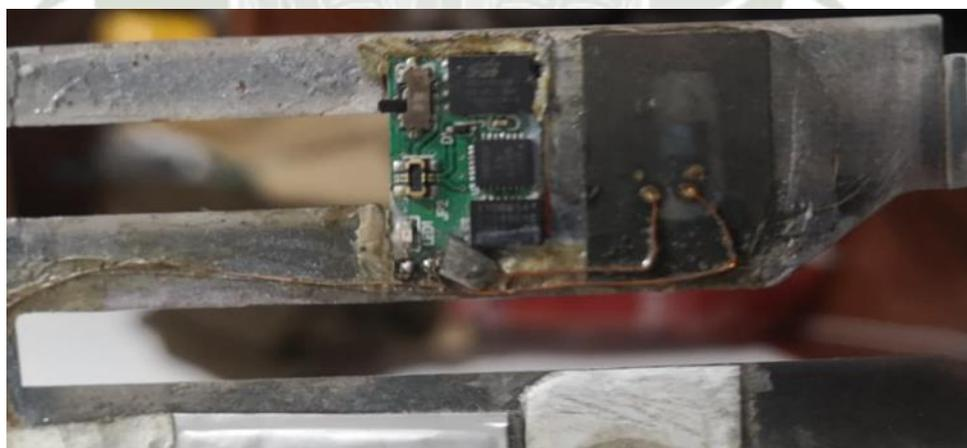
*Nota.* Tendrá un cabezal magnético, un sistema de transferencia de datos y una batería para alimentación de todo. Adaptación propia en base a la investigación realizada.
