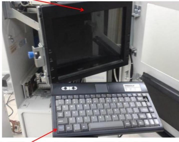
Nota. En la parte superior la pantalla y en la parte inferior el teclado de operador. Adaptación propia en base a la investigación realizada.
