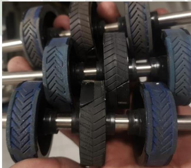
*Nota.* Se puede observar el desgaste de los feed shaft sobre todo en los bordes. Adaptación propia en base a la investigación realizada.
