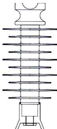
Figura N°. 15. Aislador polimérico tipo PIN
