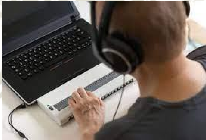
Figura 5 Teclado adaptado para usuario con invidencia
