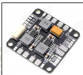
**Figura 2.26.** Placa de Distribución de Energía.
