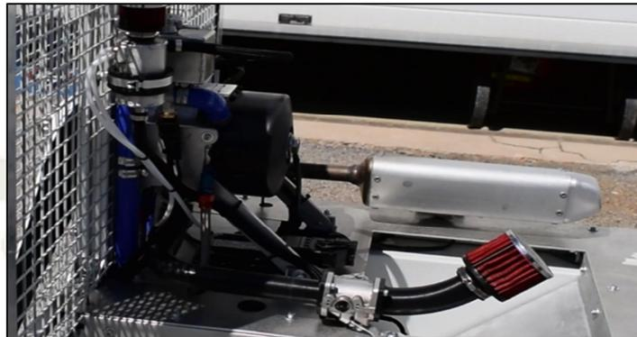
**Figura 2.19.** Sistema de Generación a Gasolina tipo Wankel de 35KW.
