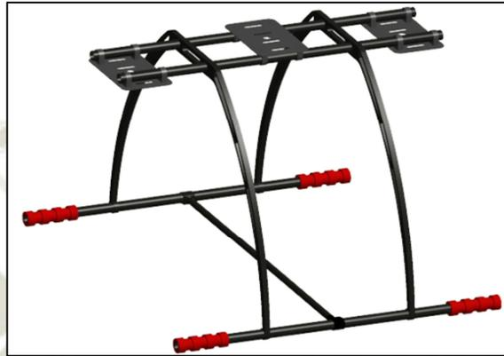
**Figura 4.22.** Diseño de Tren de Aterrizaje para VANT.
