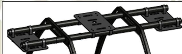
**Figura 4.33.** Tubos de soporte transversales al frame de VANT.
