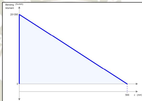
**Figura 4.7.** Diagrama de Momento Flector en Viga de Articulación de Motores Brushless.
