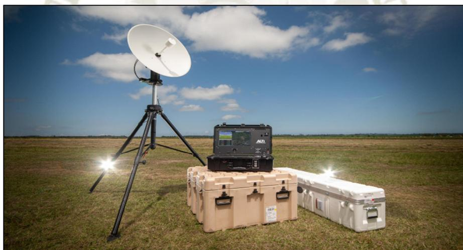
**Figura 2.25.** Sistema de control de vuelo y localización satelital ALTI C2 Advanced.
