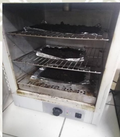
Figura 33. Proceso de secado del carbón activado
