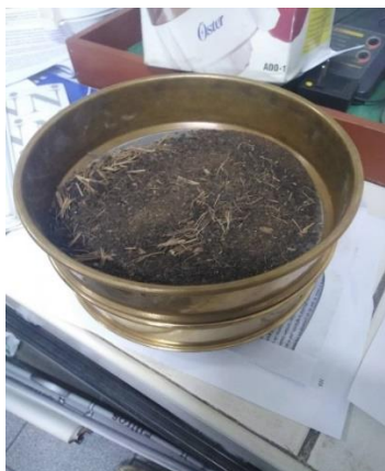
Figura 29. Proceso de tamizado de precursor de cáscara de plátano
