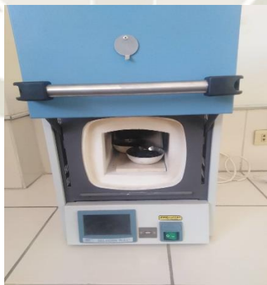
Figura 31. Uso de mufla para la obtención de carbón activado de los precursores
