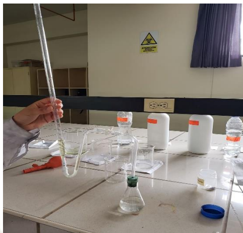
Figura 38. Sistema de generador Gutzeit para remoción de arsénico
