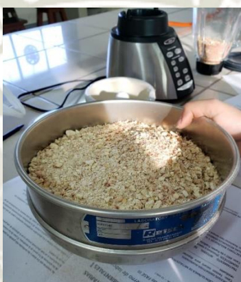
Figura 30. Proceso de tamizado de precursor de coronta de maíz
