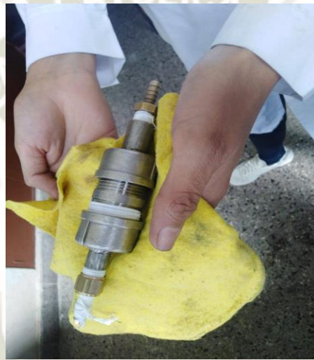
Figura 36. Proceso de armado de filtros con carbón activado
